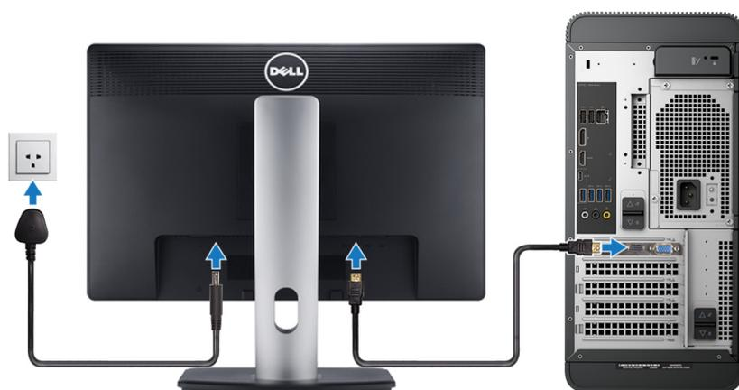
**NOTA:** Se encomendou o seu computador com uma placa gráfica independente, a porta HDMI e as portas DisplayPort no painel posterior do seu computador estarão tapadas. Ligue o monitor à placa gráfica independente.
