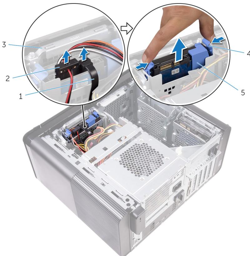
Figure 13. Retrait de l'assemblage du disque dur
