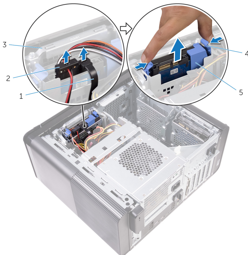
Slika 13. Uklanjanje sklopa čvrstog diska
