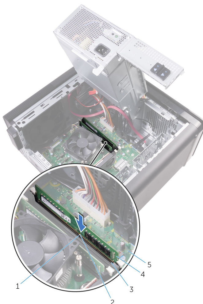
Obrázok 25. Spätná montáž pamäťového modulu
