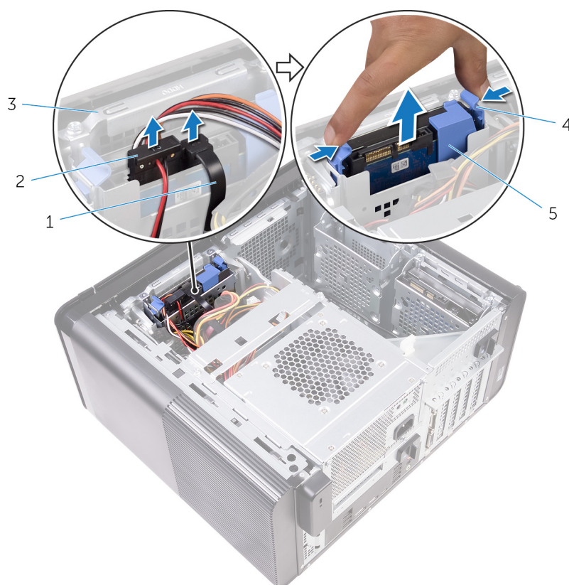
Obrázok 13. Demontáž zostavy pevného disku
