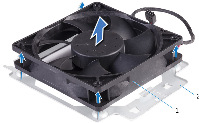
Рисунок 35. Снятие вентилятора корпуса
