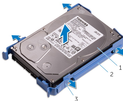
Рисунок 14. Извлечение жесткого диска из контейнера
