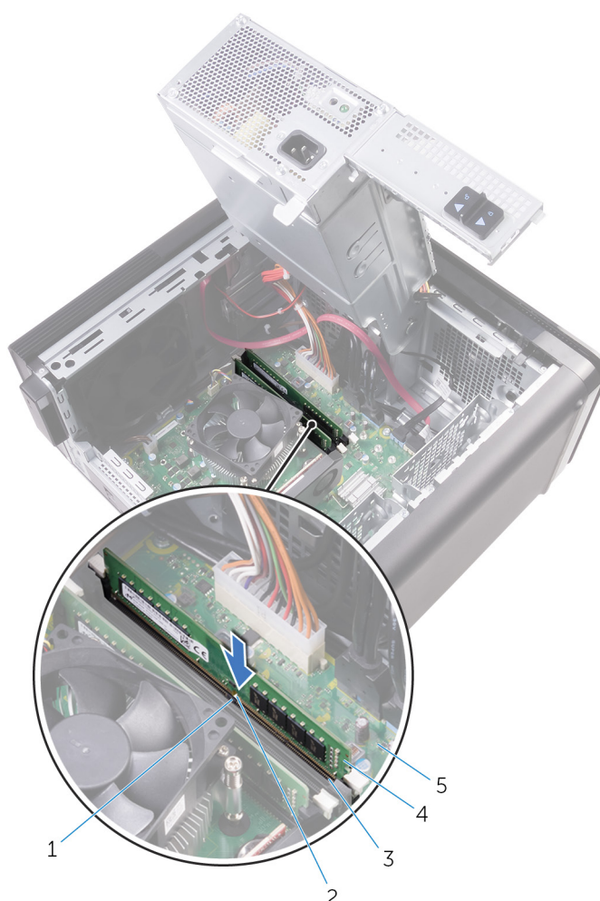
Figura 25. Remontarea modulului de memorie
