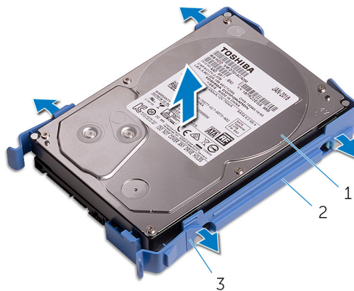
Figura14. Remover a unidade de disco rígido do suporte
