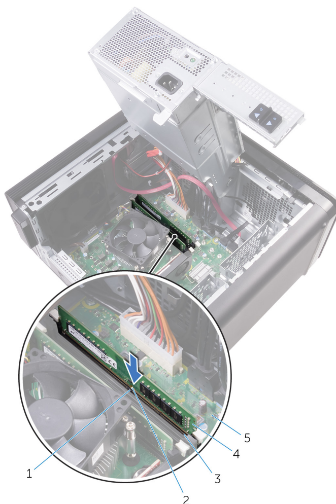
Figura 25. Como recolocar o módulo de memória
