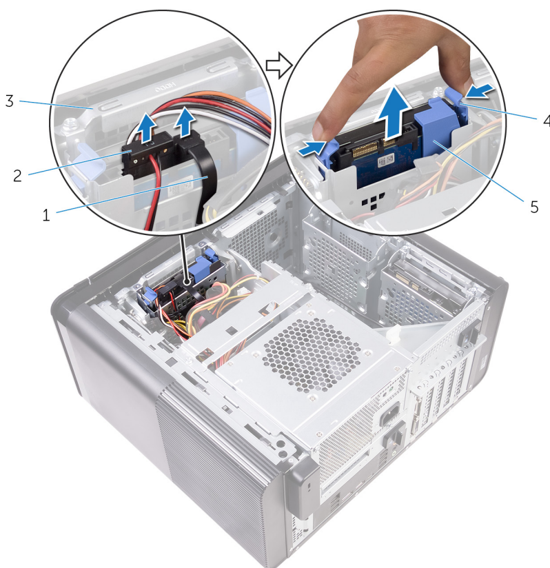
Figura 13. Como remover o conjunto do disco rígido
