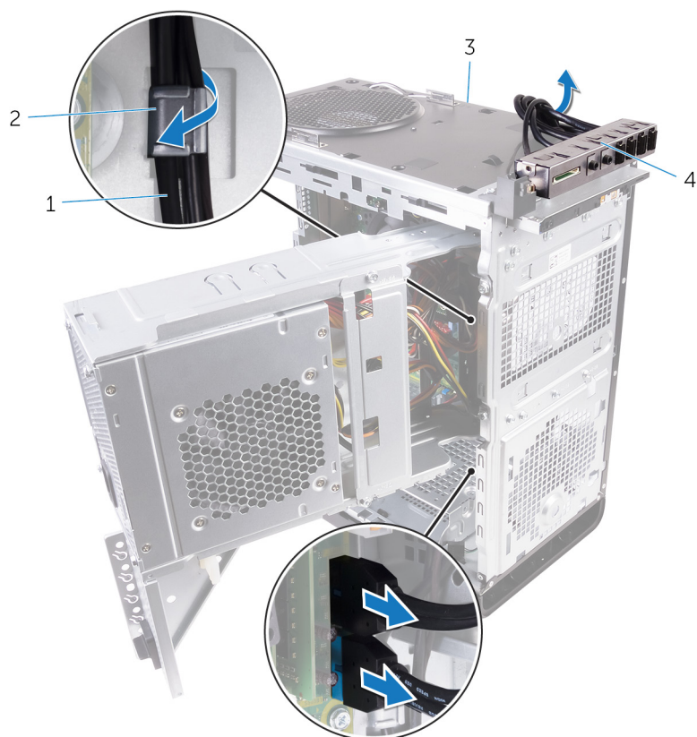
Figura 27. Como desconectar os cabos
