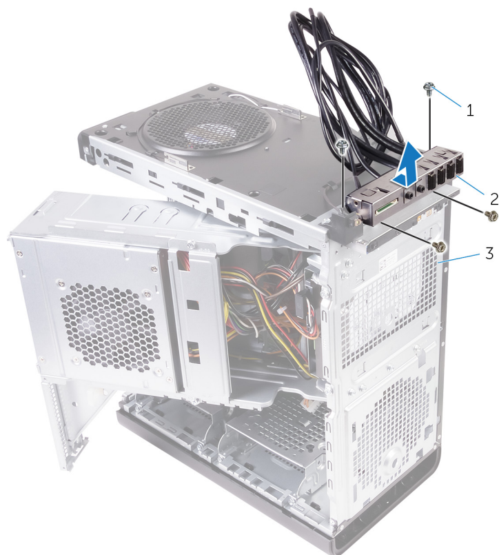
Figura 28. Como remover o painel USB
