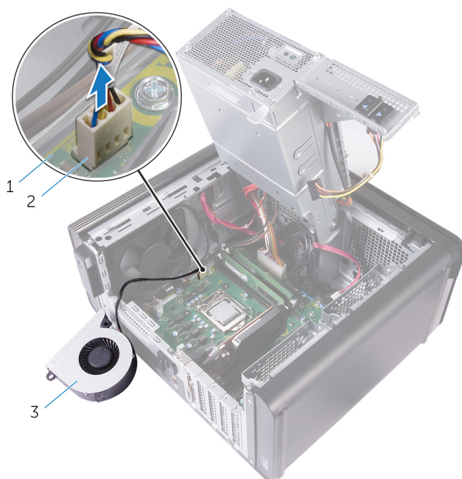
Rysunek 31. Wymontowywanie kabla wentylatora
