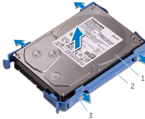
Afbeelding 14. De harde schijf uit de beugel verwijderen
