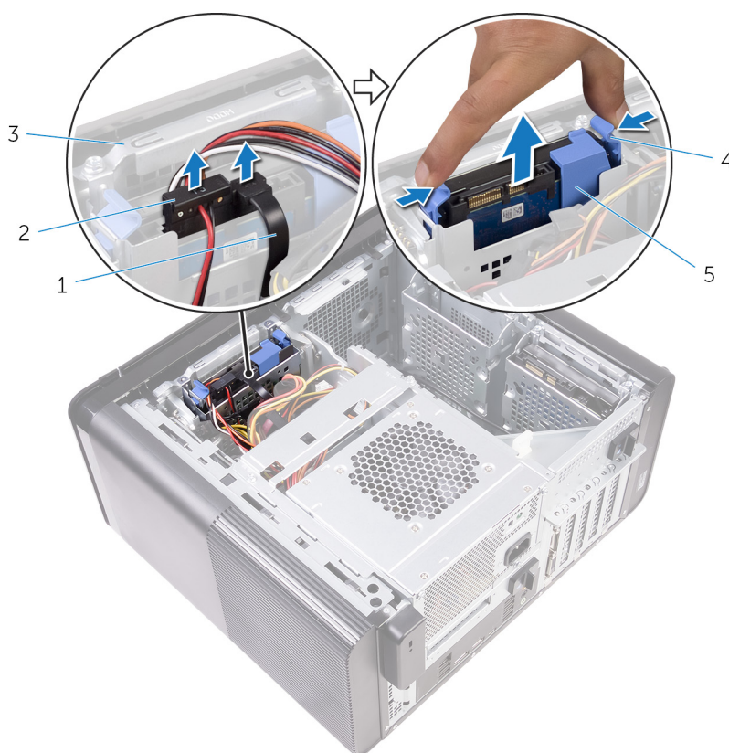
Afbeelding 13. De harde schijf verwijderen
