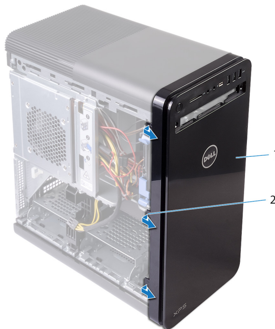
Afbeelding 3. Het montagekader aan de voorkant verwijderen
