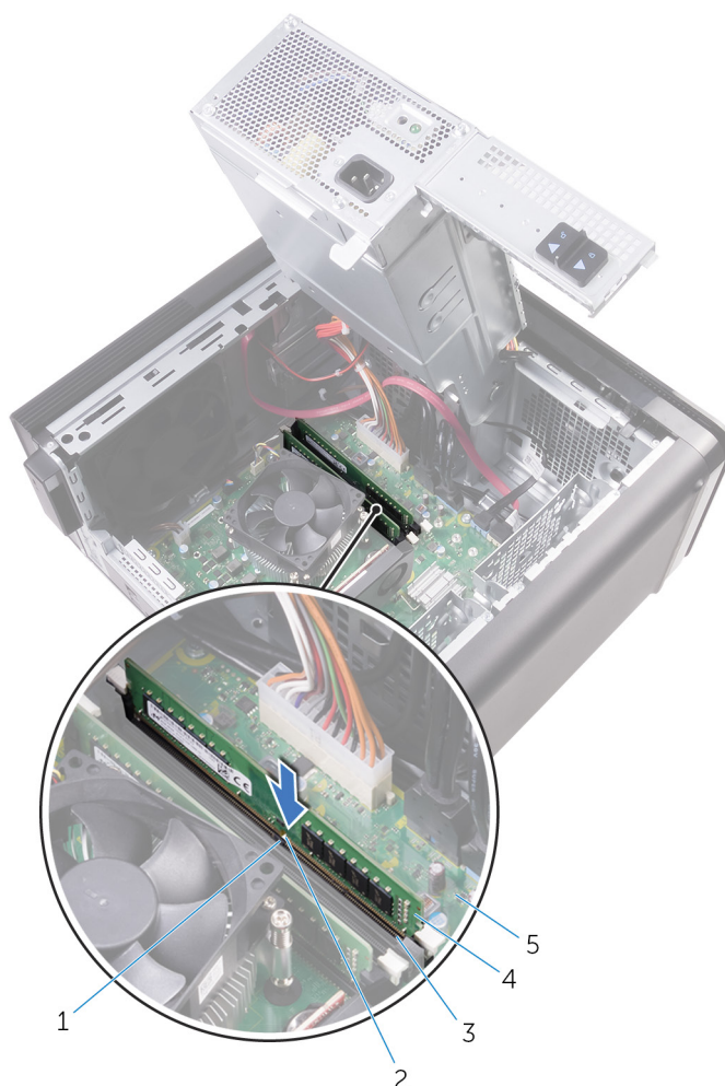
Afbeelding 25. De geheugenmodule vervangen
