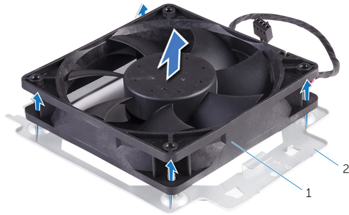
Afbeelding 35. De chassisventilator verwijderen
