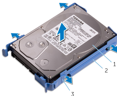
Figura 14. Rimozione del disco rigido dalla relativa staffa
