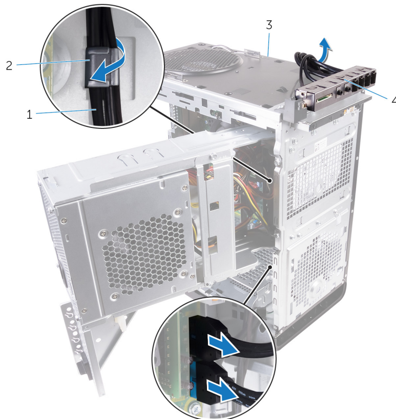
27. ábra. A kábelek lecsatlakoztatása
