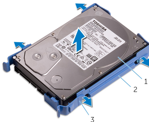
14. ábra. A merevlemez eltávolítása a tartókeretből
