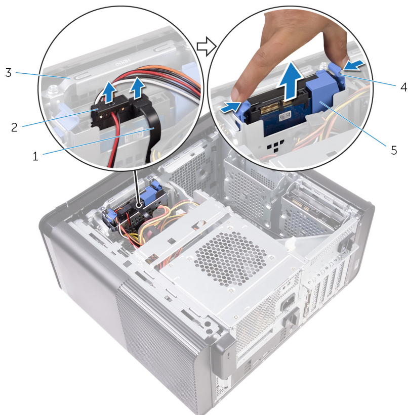
Slika 13. Uklanjanje sklopa tvrdog pogona
