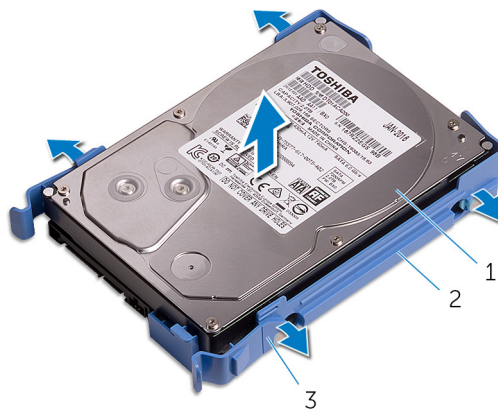
Figure 14. Image : retrait du disque dur de son support
