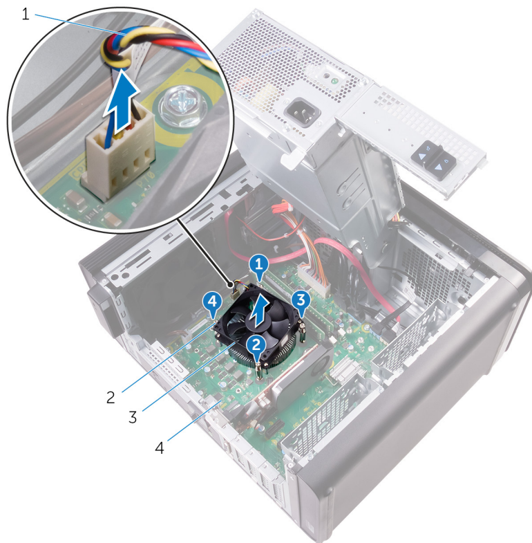
Abbildung 33. Entfernen des Prozessorlüfters und des Kühlkörpers
