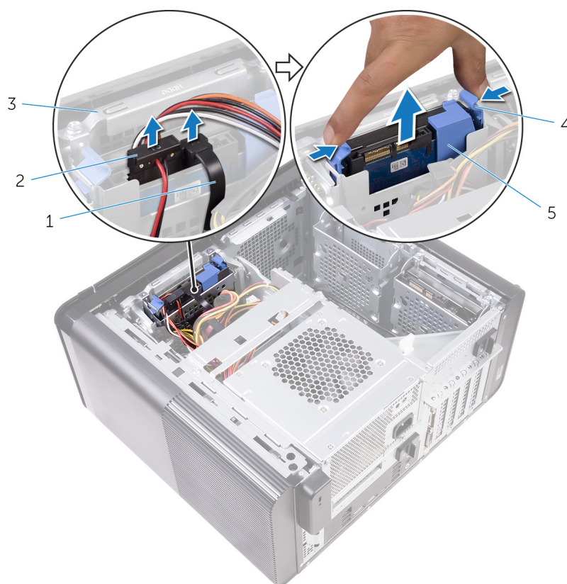
Abbildung 13. Entfernen der Festplattenbaugruppe
