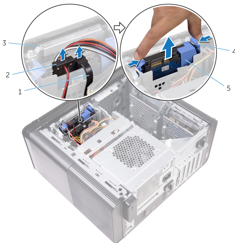
Obrázek 13. Demontáž sestavy pevného disku
