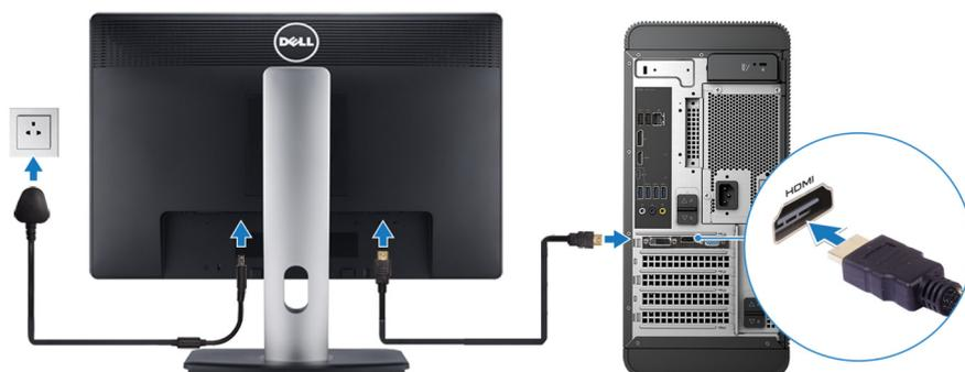
**NOTA:** Se o computador tiver sido adquirido com uma placa gráfica dedicada, as portas HDMI e DisplayPort no painel traseiro do computador estarão cobertas. Conecte a tela à placa gráfica separada.
