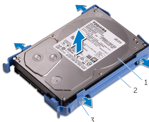
Рисунок 13. Извлечение жесткого диска из контейнера
