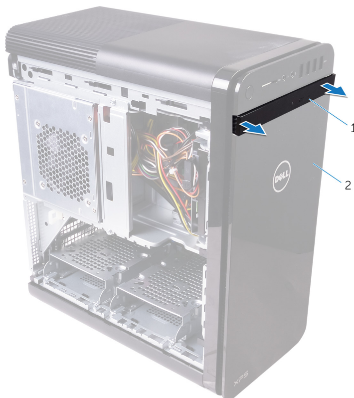
Рисунок 3. Удаление лицевой панели оптического привода
