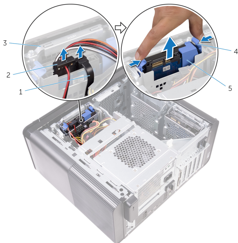
Рисунок 12. Извлечение жесткого диска в сборе
