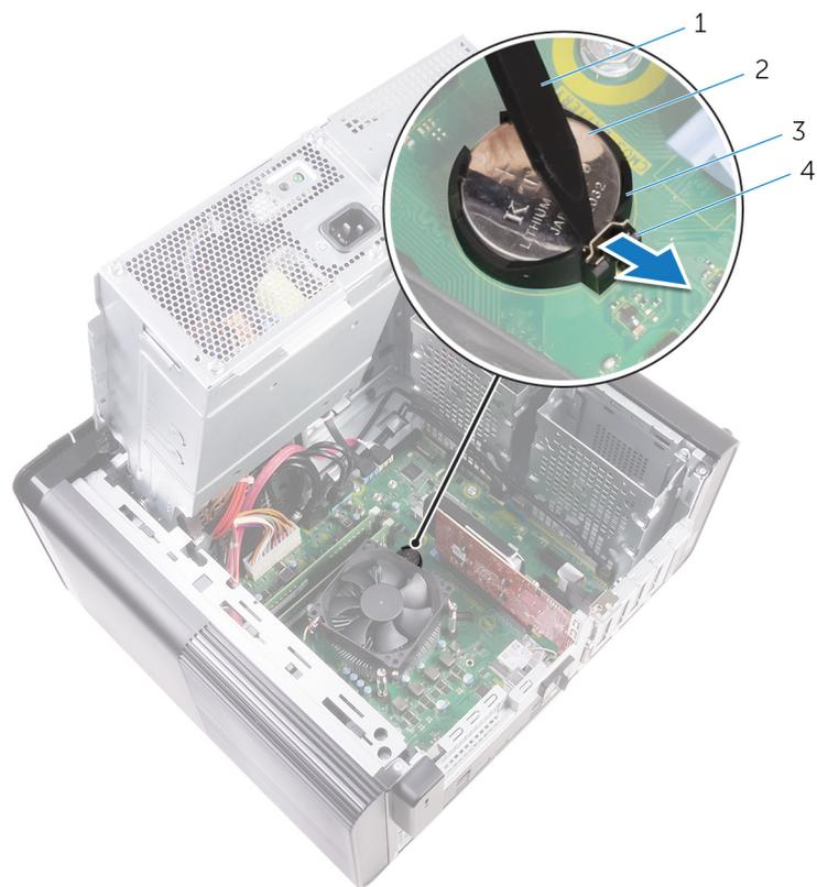
**Figura22. Remoção da bateria de célula tipo moeda**
