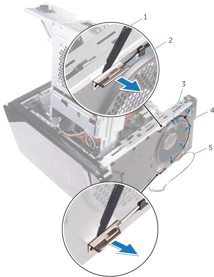
**Figura43. Remoção da antena**
