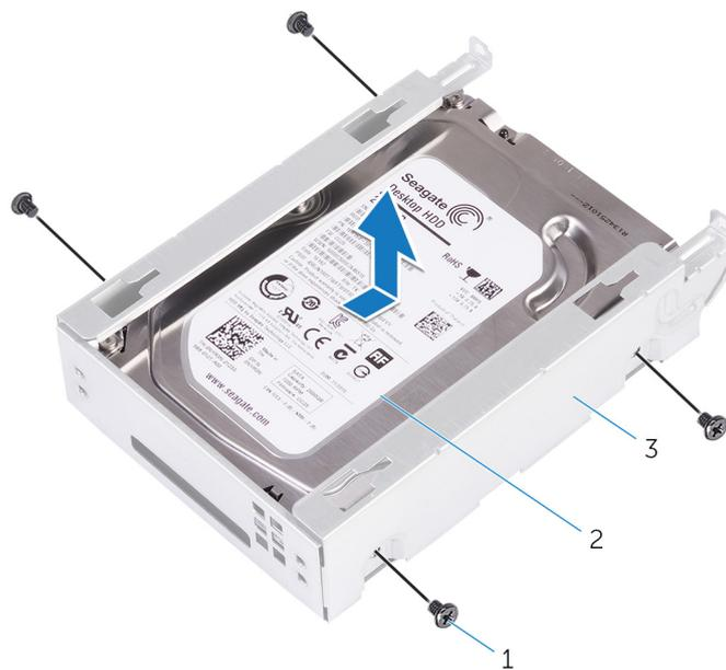
**Figura16. Retirar a unidade de disco rígido do suporte**
