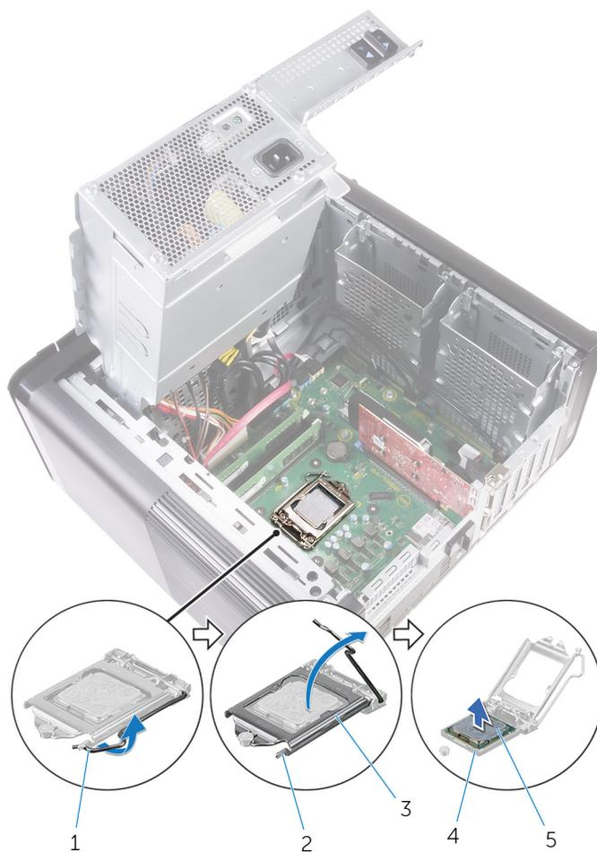
**Figura38. Retirar o processador**
