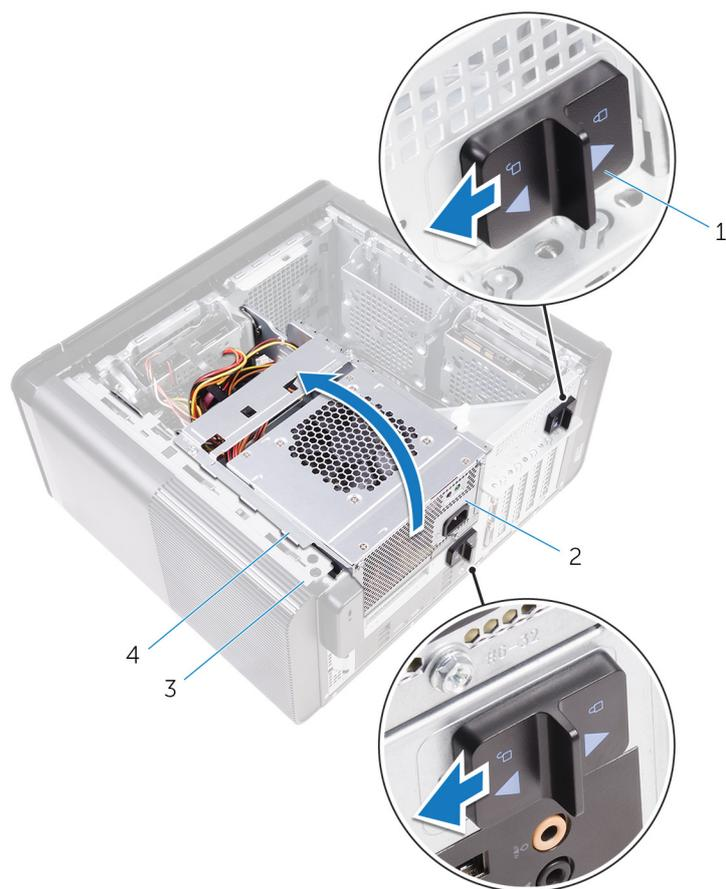
**Figura19. Rodar a unidade da fonte de alimentação**
