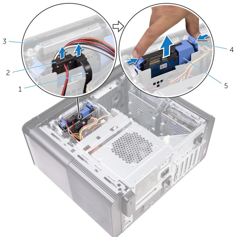
**Figura12. Remover o conjunto da unidade de disco rígido**
