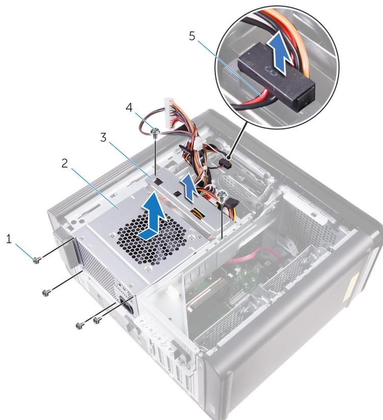
**Figura21. Retirar a unidade de fonte de alimentação**
