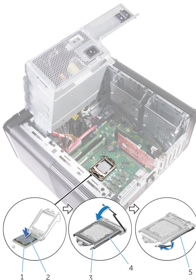
**Figura39. Voltar a colocar o processador**
