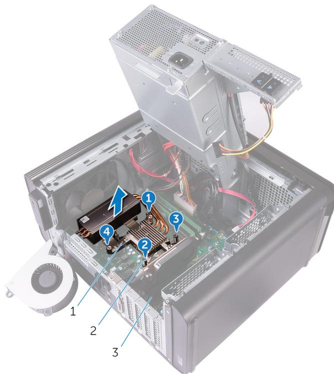
**Figura32. Retirar os parafusos integrados**
