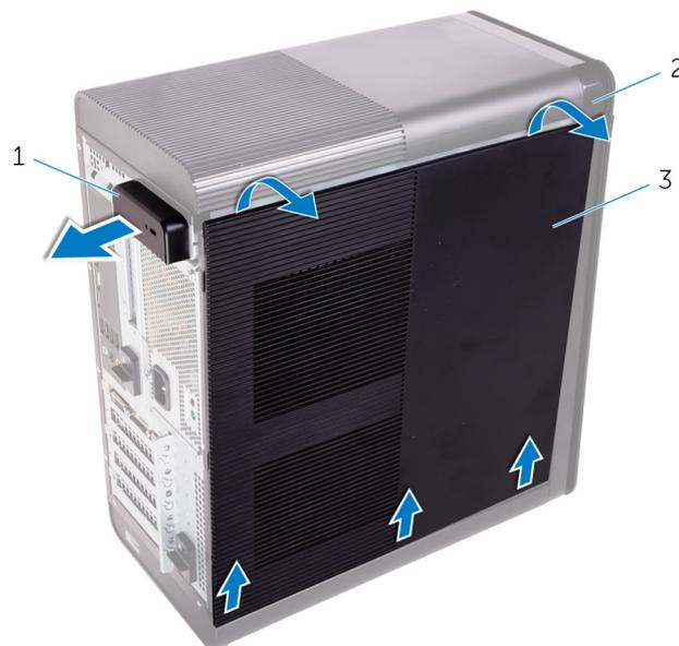
**Figura1. Remoção da tampa direita**
