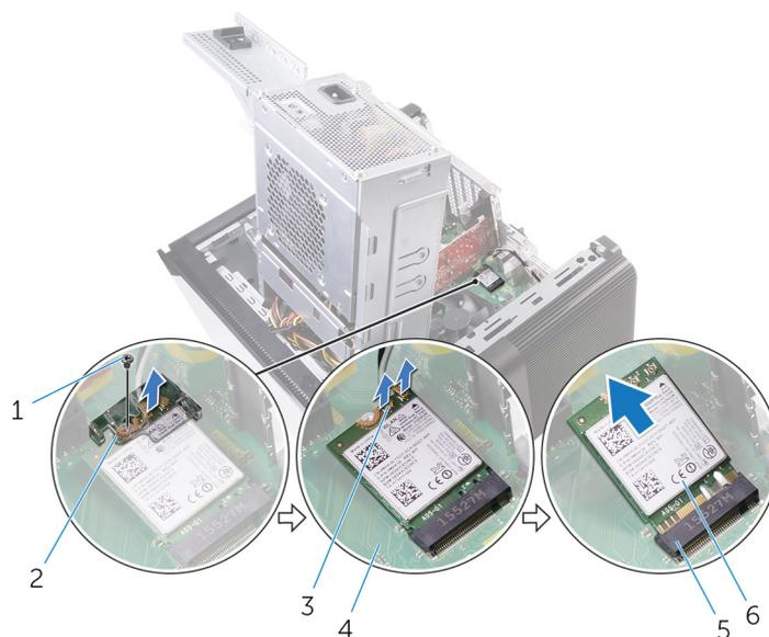
**Figura40. Retirar a placa de rede sem fios**
