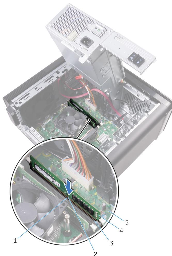
**Figura27. Substituir o módulo de memória**
