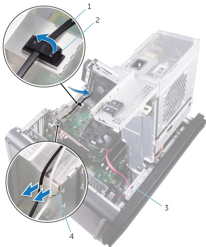
**Figura42. Desligar os cabos da antena**
