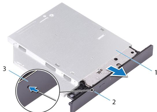
**Figura8. Retirar a moldura da unidade ótica**
