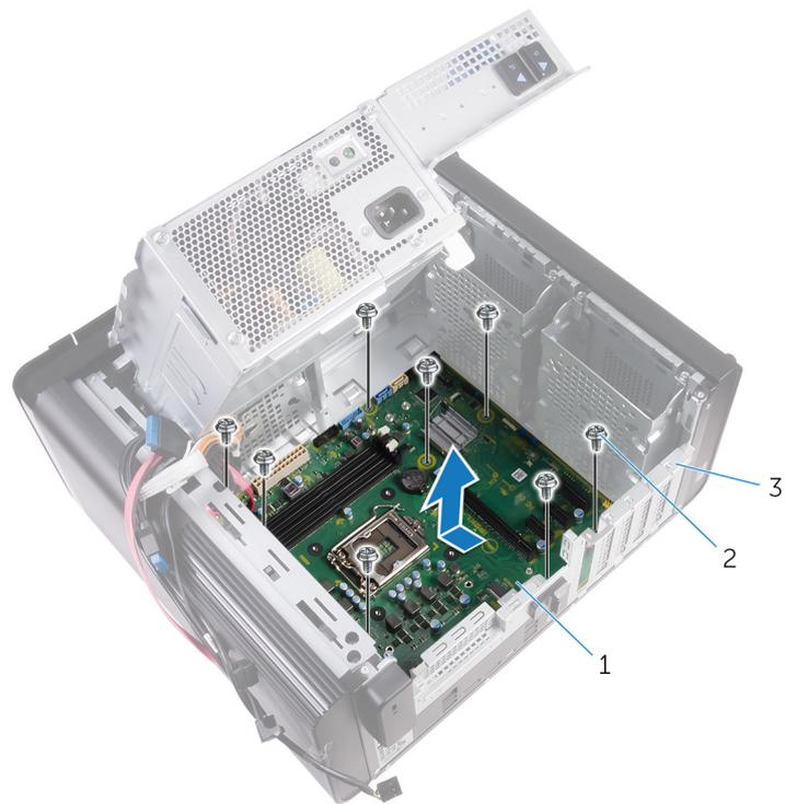
**Figura44. Retirar a placa de sistema**
