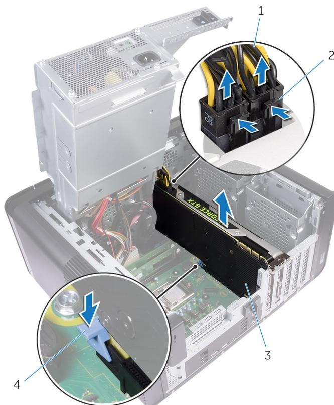
**Figura25. Retirar o cabo de alimentação**
