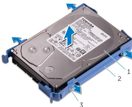
**Figura13. Remover a unidade de disco rígido do suporte**
