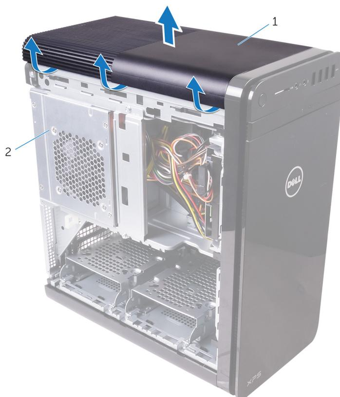
**Figura10. Remoção da tampa superior**
