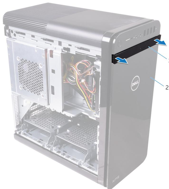
**Figura3. Retirar a moldura da unidade ótica**
