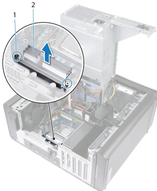
Figura34. Retirar o dissipador de calor VR
