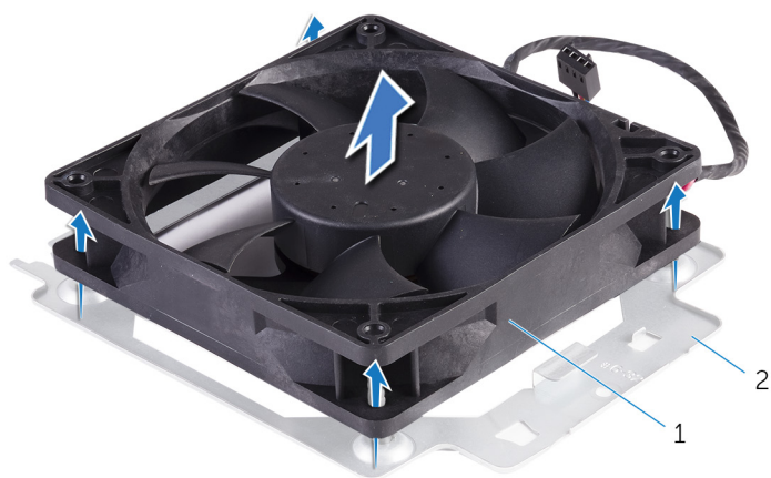
Afbeelding 37. De chassisventilator verwijderen
