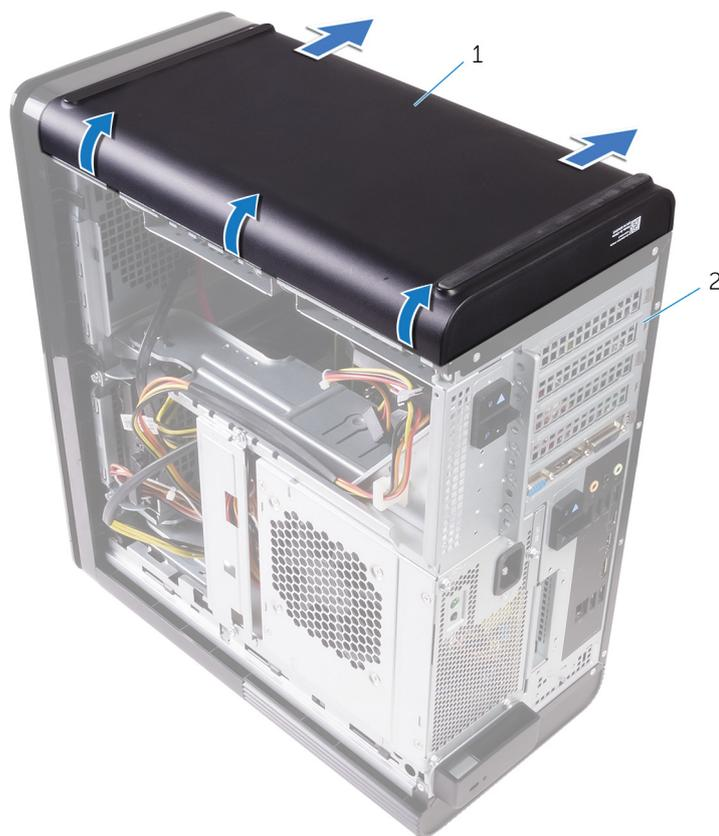
図 11. 底部カバーの取り外し
