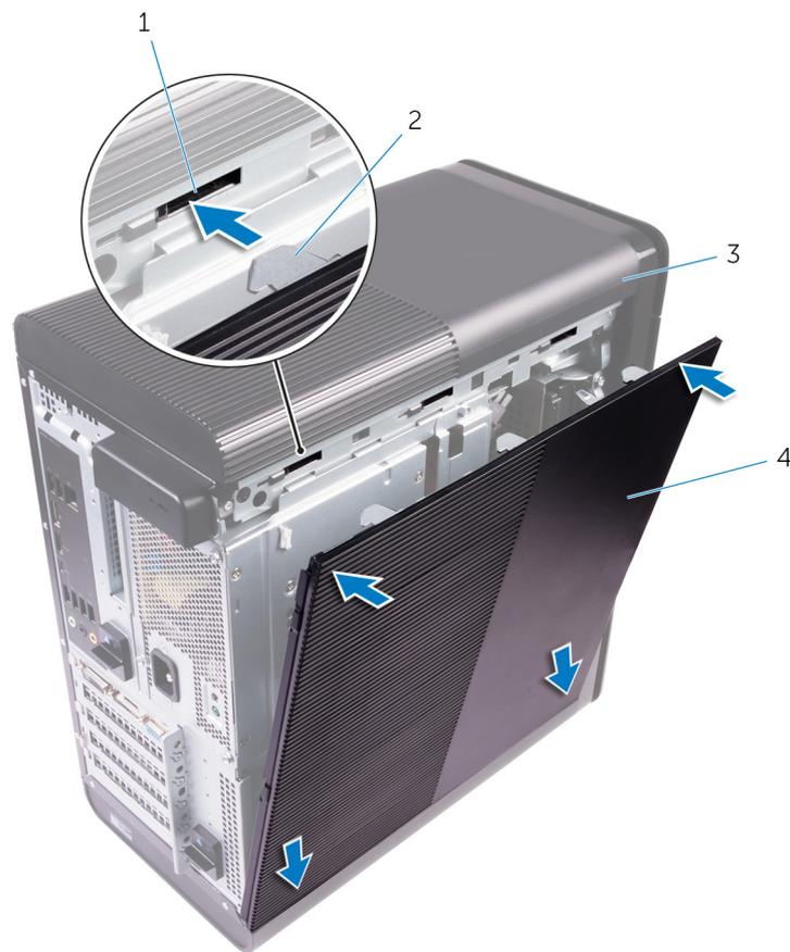
図 2. 右側カバーの取り付け
