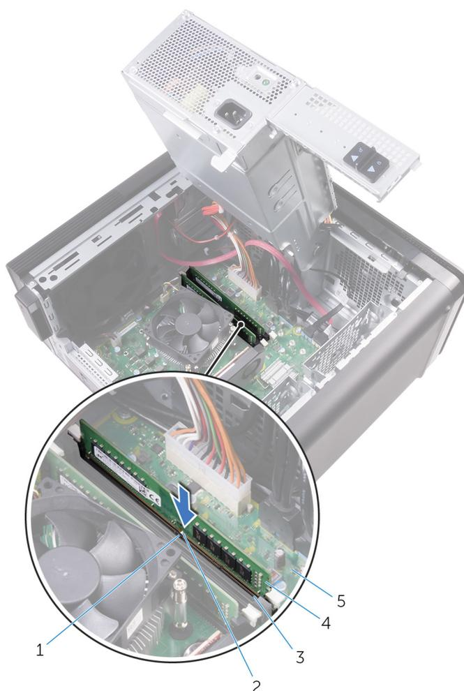
図 27. メモリーモジュールの取り付け
