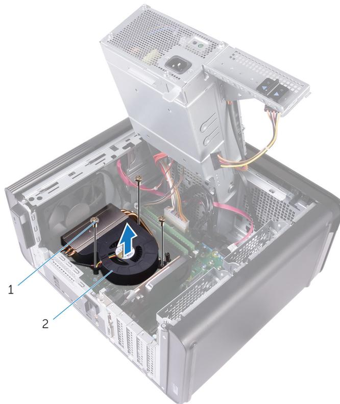
図 31. 送風装置の取り外し
