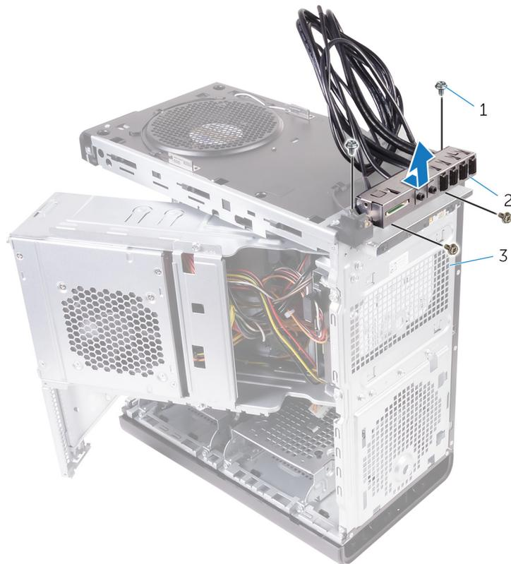
図 30. USB パネルの取り外し
