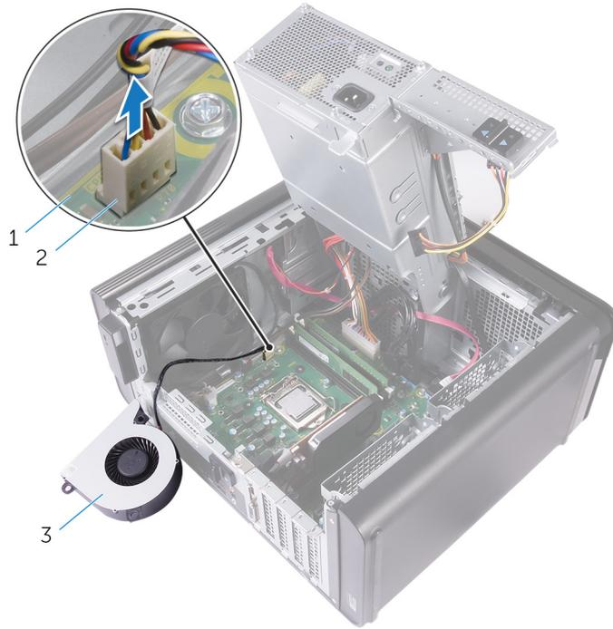
図 33. 送風装置ケーブルの取り外し
