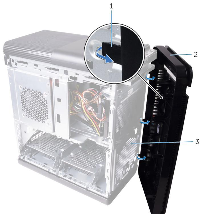
**Figura 4. Rimozione del frontalino anteriore**
