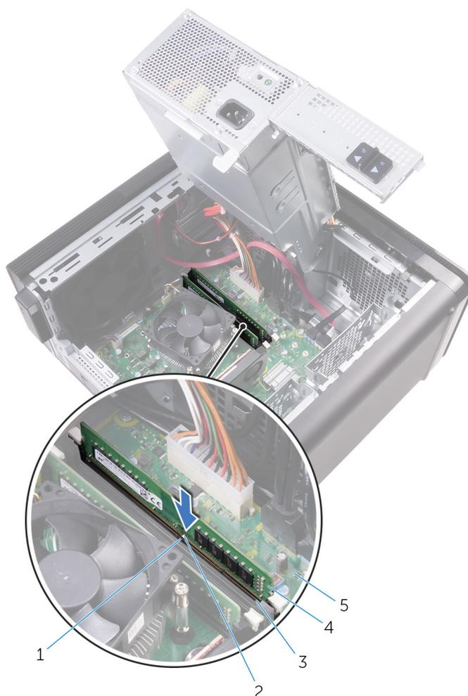
**Figura 27. Ricollocamento del modulo di memoria**
