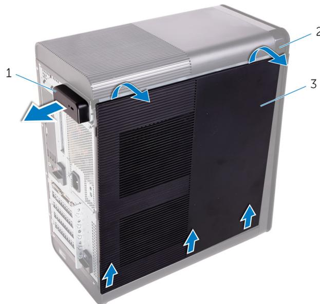
**Figura 1. Rimozione del pannello laterale destro**
