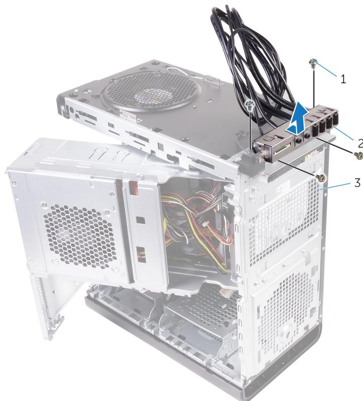
**Figura 30. Rimozione del pannello USB**
