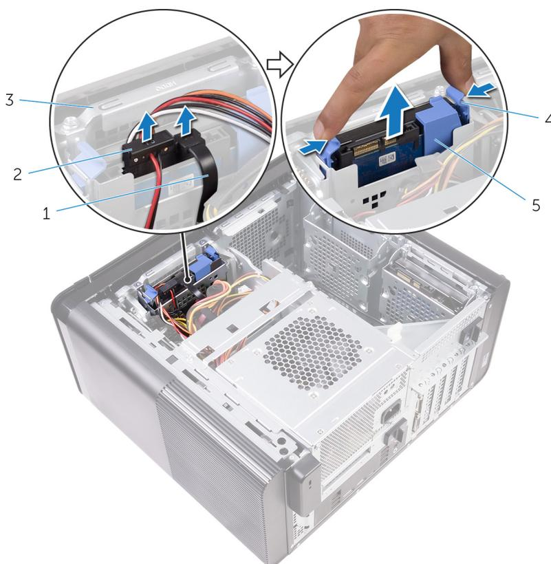
**Figura 12. Rimozione del gruppo del disco rigido**
