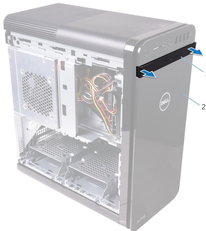
**Figura 3. Rimozione del frontalino dell'unità ottica**
