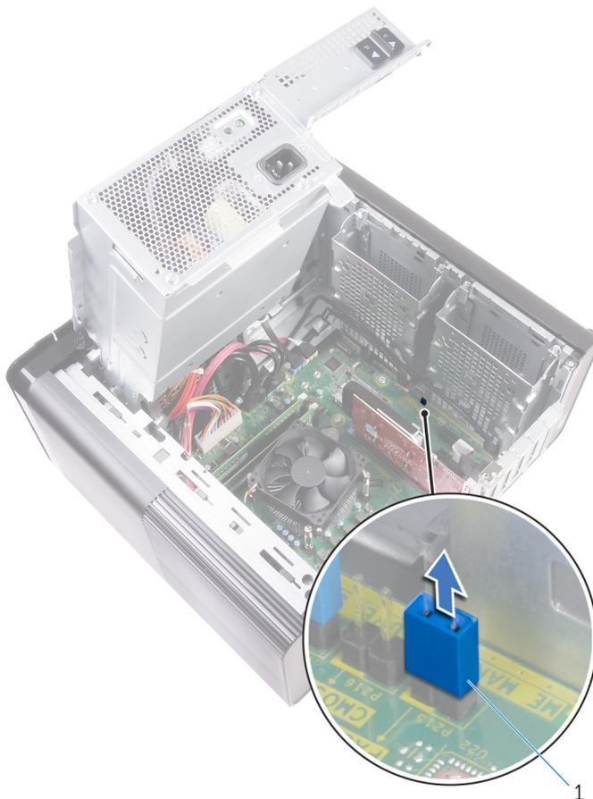
**Figura 46. Rimozione della spina del ponticello**
