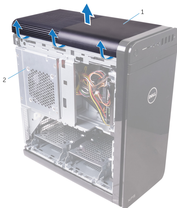
Figure 10. Retrait du capot supérieur de l'ordinateur
