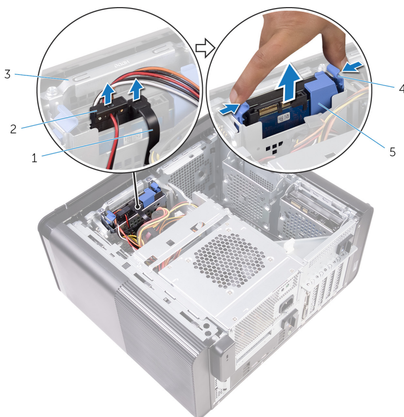
Figure 12. Retrait de l'assemblage du disque dur
