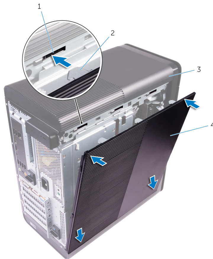
Kuva 2. Oikeanpuoleisen kannen asentaminen
