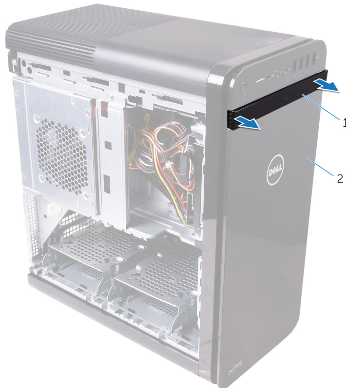
Kuva 3. Optisen aseman kehyyksen irrottaminen
