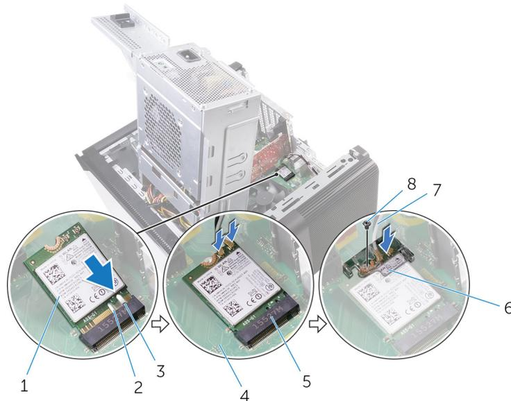
**Ilustración 41. Colocación de la tarjeta inalámbrica**
