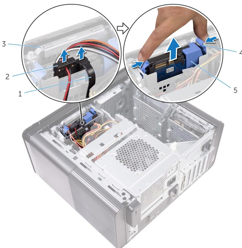
**Ilustración 12. Extracción del ensamblaje de la unidad de disco duro**
