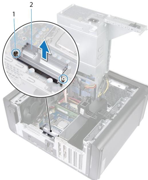
Ilustración 34. Extracción del disipador de calor de VR
