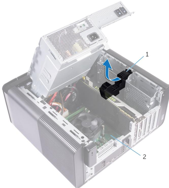
**Ilustración 24. Extracción del soporte de la tarjeta gráfica de longitud completa**
