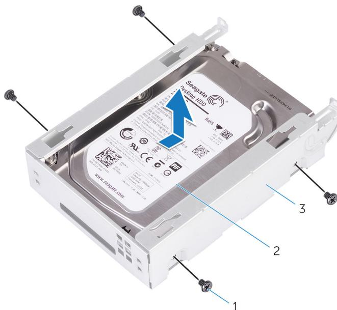
**Ilustración 16. Extracción de la unidad de disco duro del soporte**
