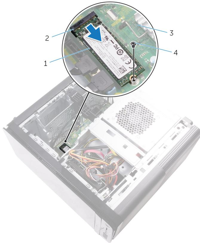
**Ilustración 17. Extracción de la unidad de estado sólido**
