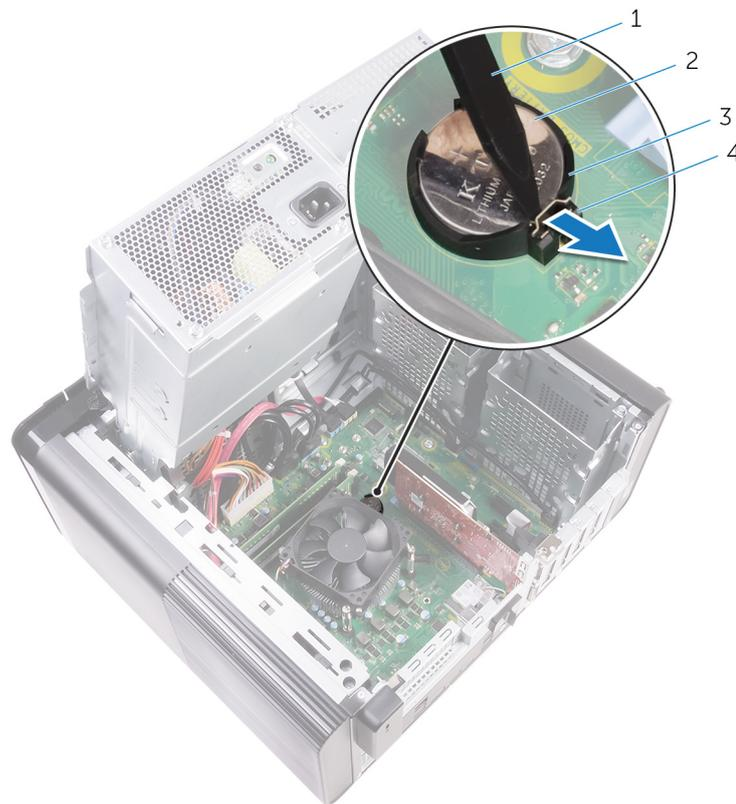
**Ilustración 22. Extracción de la batería de tipo botón**
