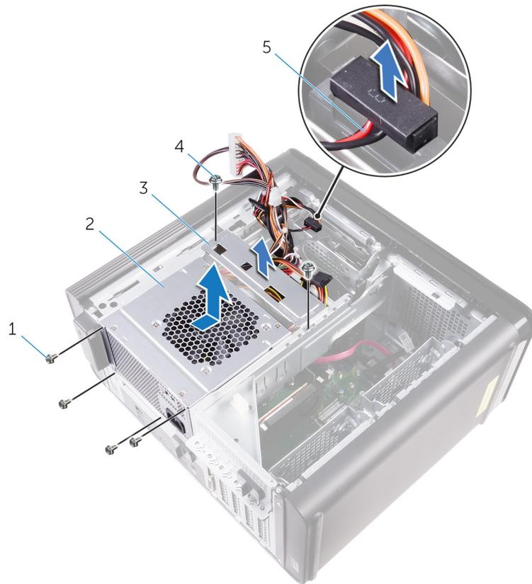
**Ilustración 21. Extracción de la unidad del sistema de alimentación**
