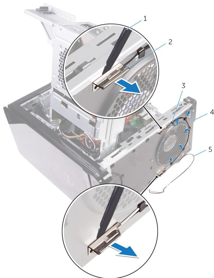
**Ilustración 43. Extracción de la antena**
