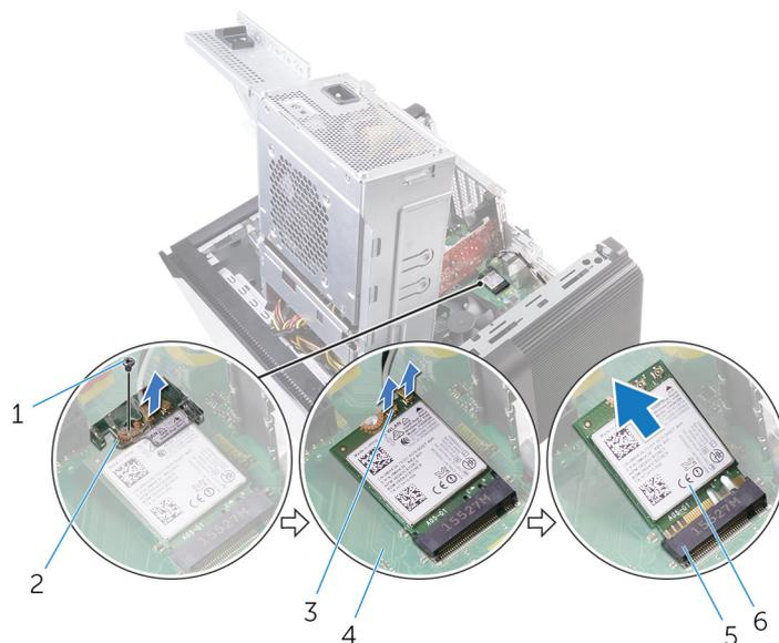
**Ilustración 40. Extracción de la tarjeta inalámbrica**
