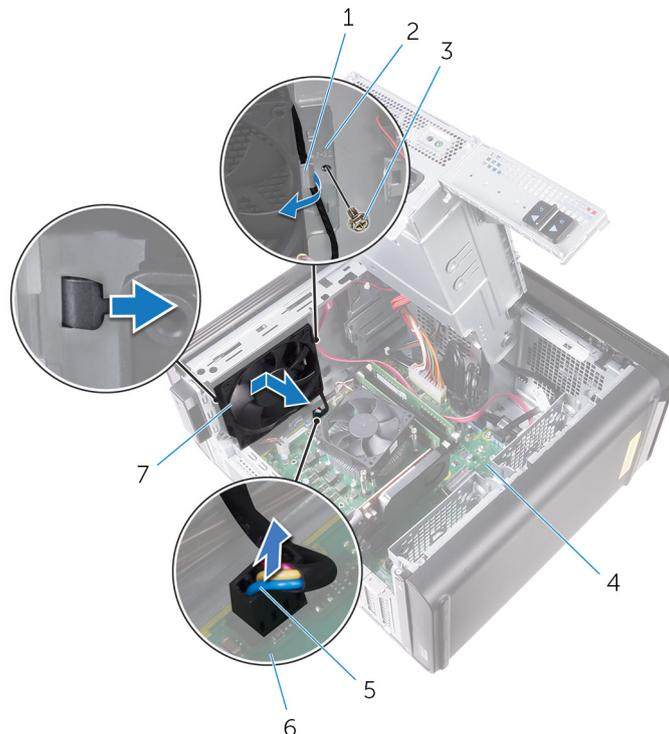
**Ilustración 36. Extracción del ventilador del chasis**
