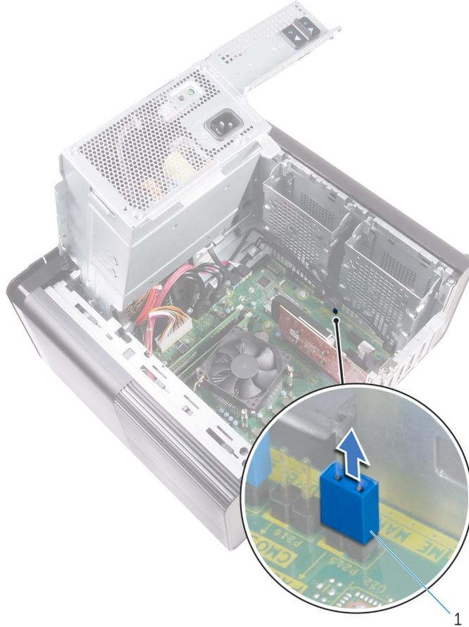
**Ilustración 46. Extracción del conector del puente**
