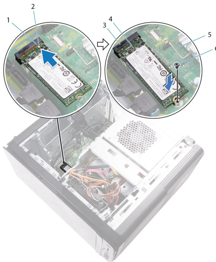
**Ilustración 18. Colocación de la unidad de estado sólido**
