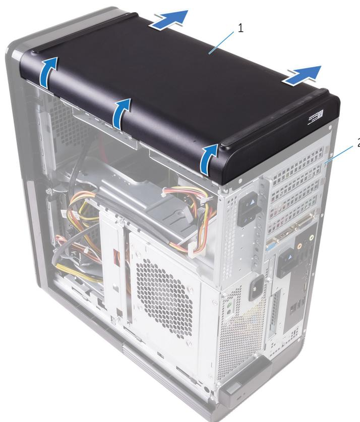
**Ilustración 11. Extracción de la cubierta inferior**
