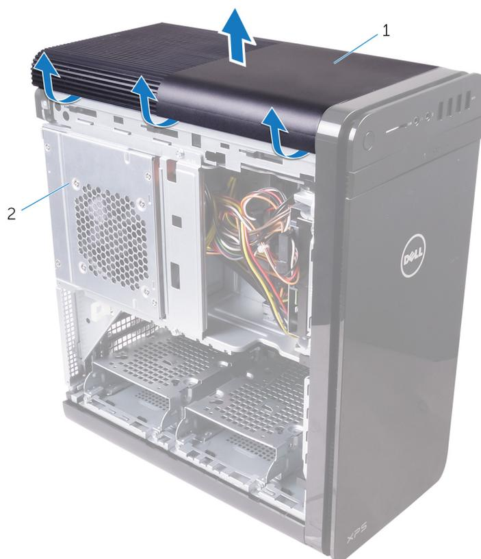
**Ilustración 10. Extracción de la cubierta superior**
