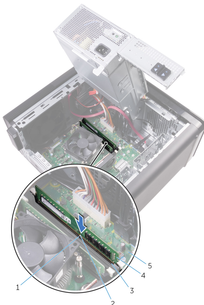
Abbildung 27. Wiedereinbauen des Speichermoduls
