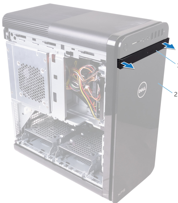
Obrázek 3. Demontáž čelního krytu optické jednotky
