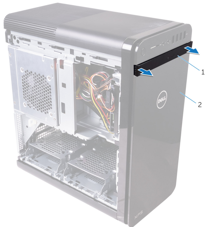
Рисунок 3. Удаление лицевой панели оптического привода
