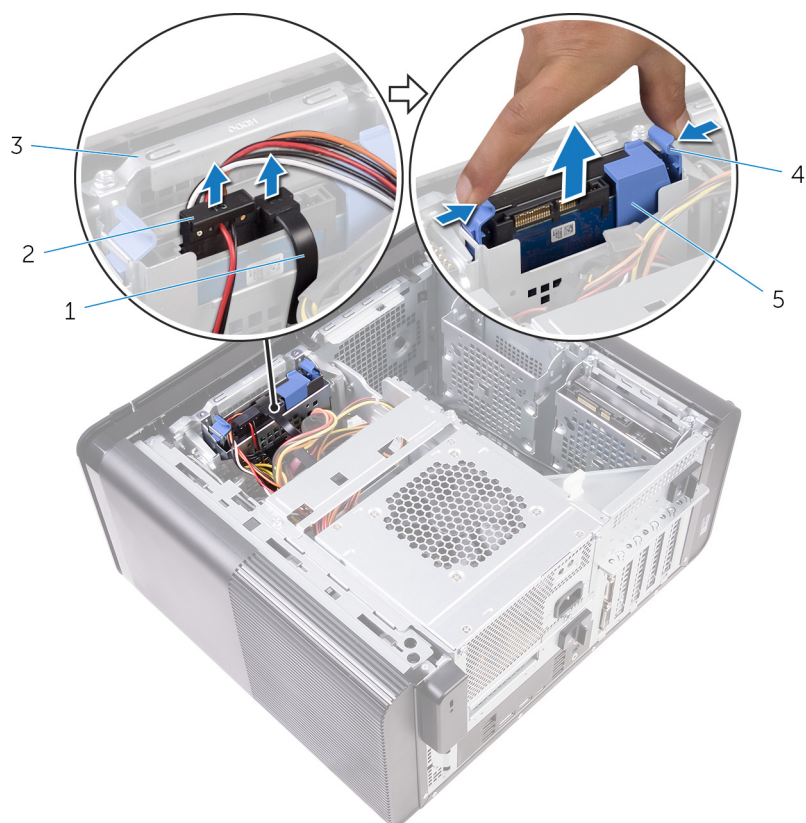
Рисунок 12. Извлечение жесткого диска в сборе
