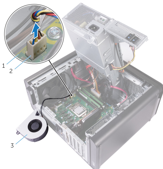
Рисунок 33. Отсоединение кабеля вентилятора
