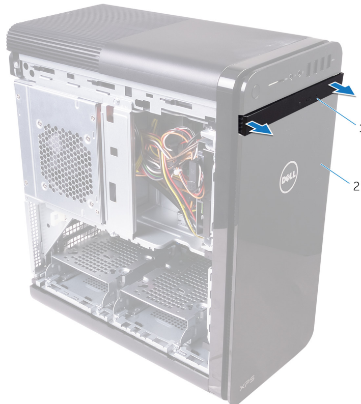
Figura 3. Scoaterea cadrului unității optice
