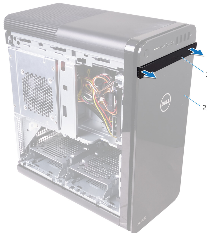
Figura3. Retirar a moldura da unidade ótica
