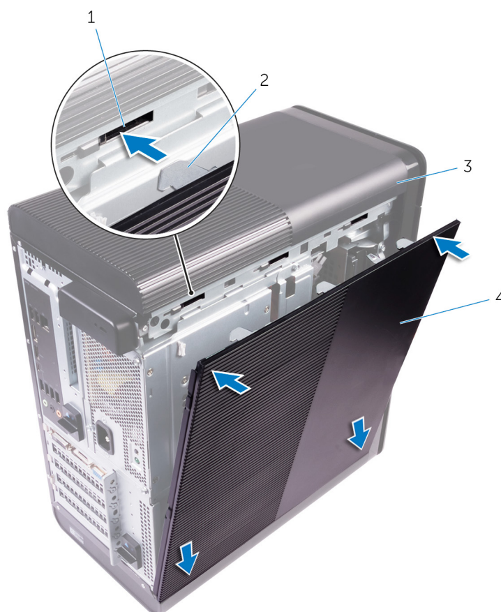
Rysunek 2. Montaż prawej pokrywy bocznej
