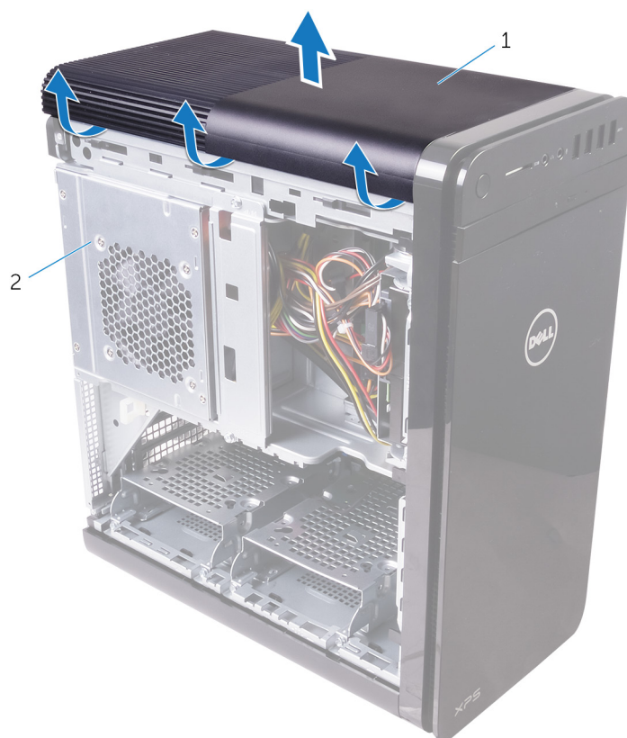
Rysunek 10. Wymontowywanie pokrywy górnej
