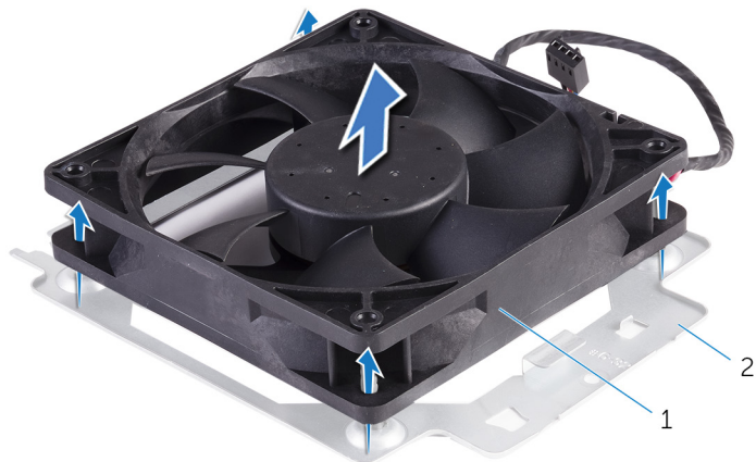
Rysunek 37. Wymontowywanie wentylatora obudowy
