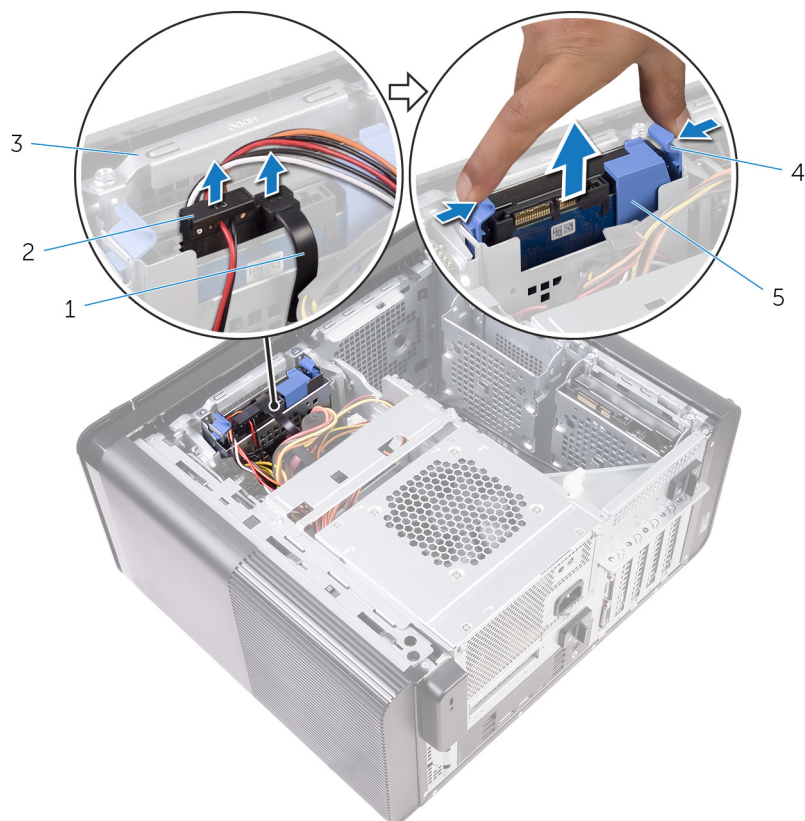
Rysunek 12. Wymontowywanie zestawu dysku twardego
