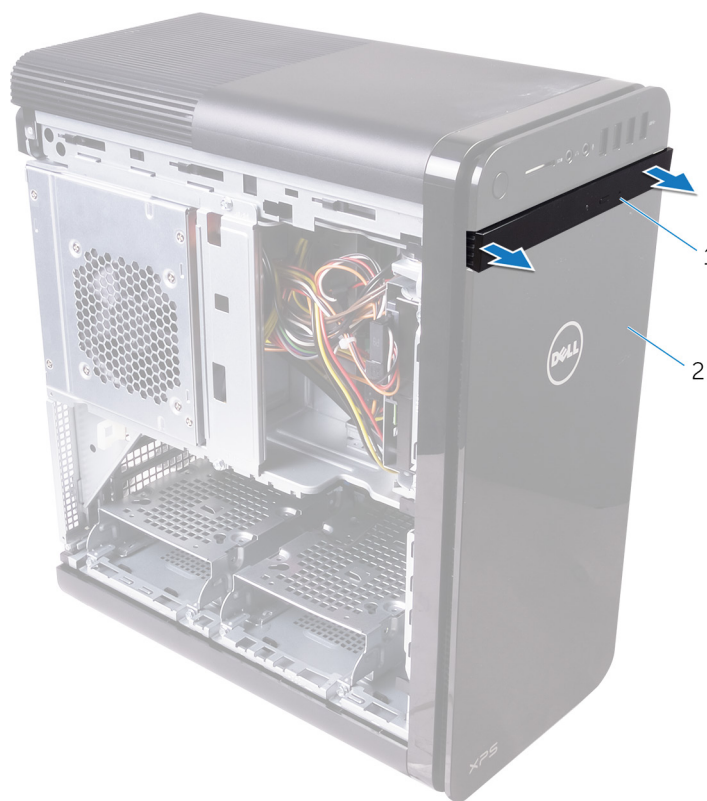
Rysunek 3. Wymontowywanie osłony napędu dysków optycznych
