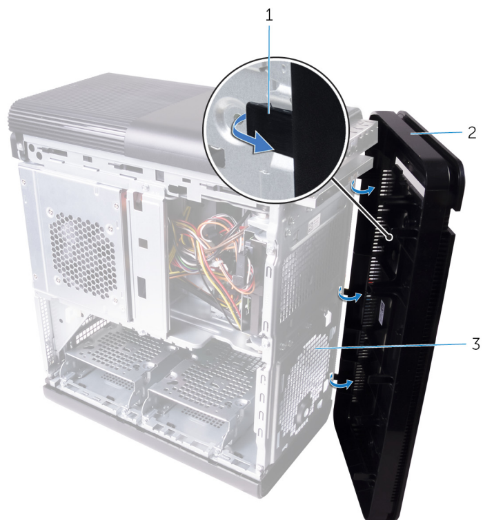
Rysunek 4. Wymontowywanie osłony przedniej
