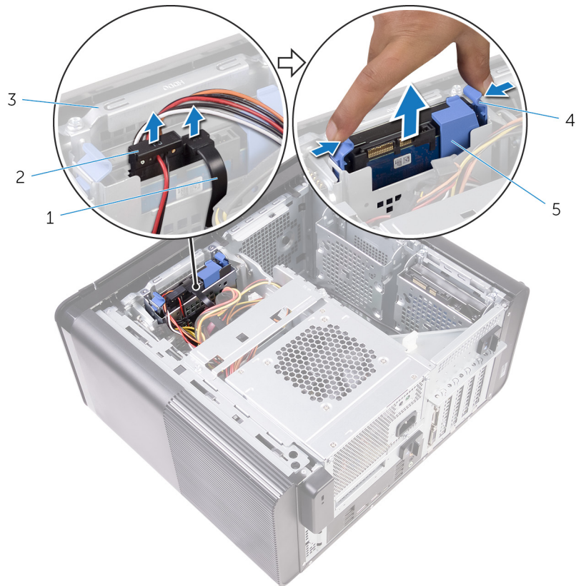
Afbeelding 12. De harde schijf verwijderen
