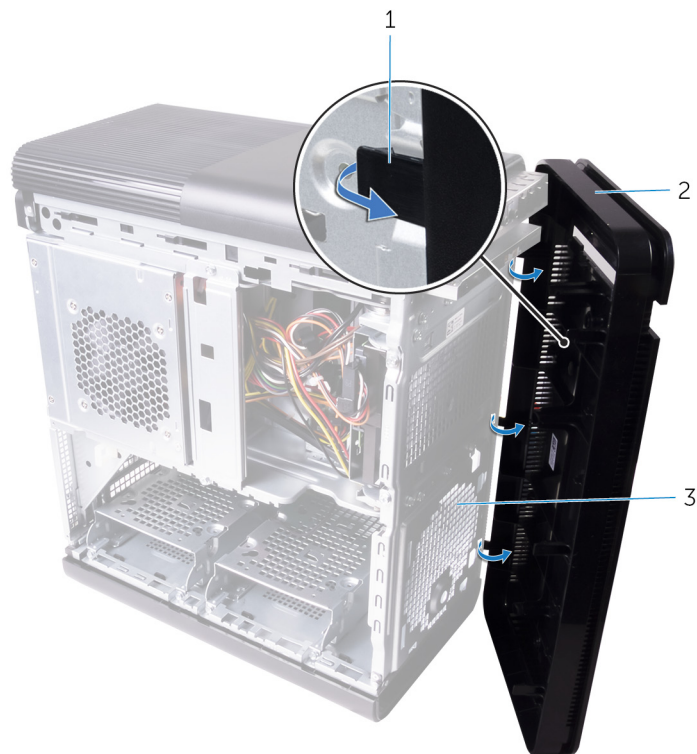
Afbeelding 4. Het montagekader aan de voorkant verwijderen
