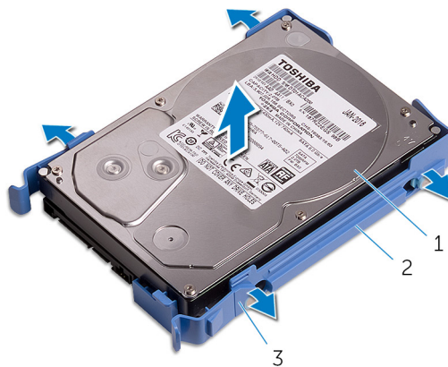
Afbeelding 13. De harde schijf uit de beugel verwijderen
