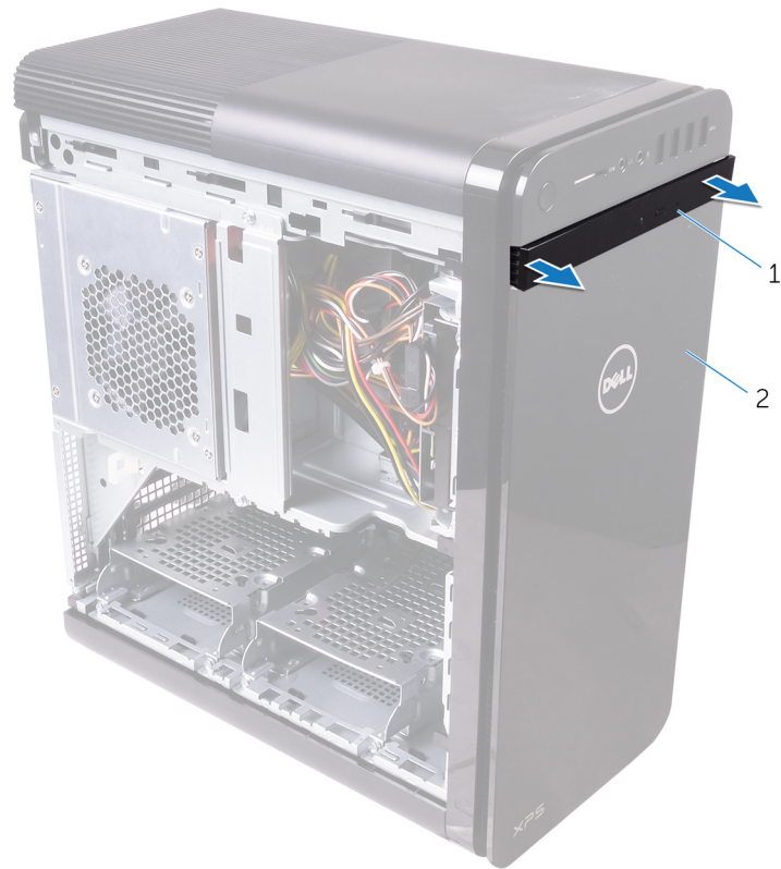
Afbeelding 3. Het optische station verwijderen
