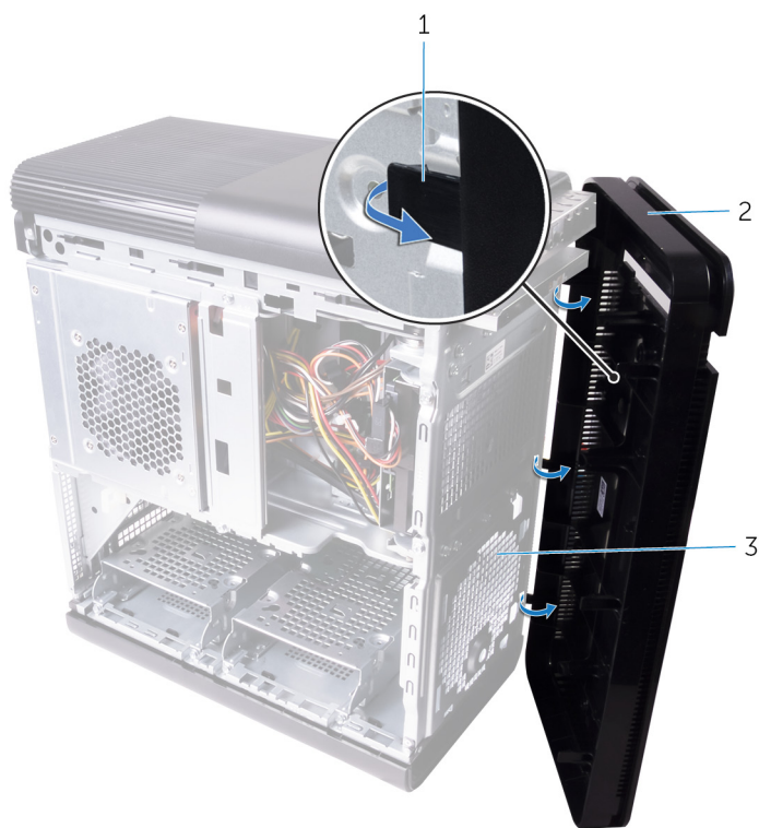
Figura 4. Rimozione del frontalino anteriore
