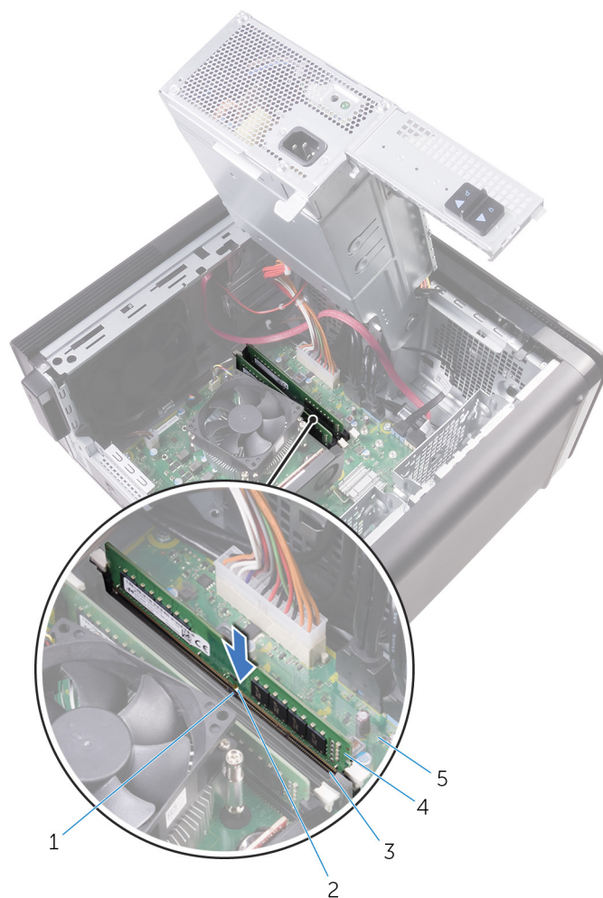
Figura 27. Ricollocamento del modulo di memoria
