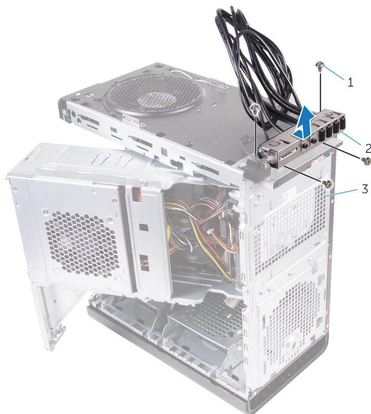
Figura 30. Rimozione del pannello USB
