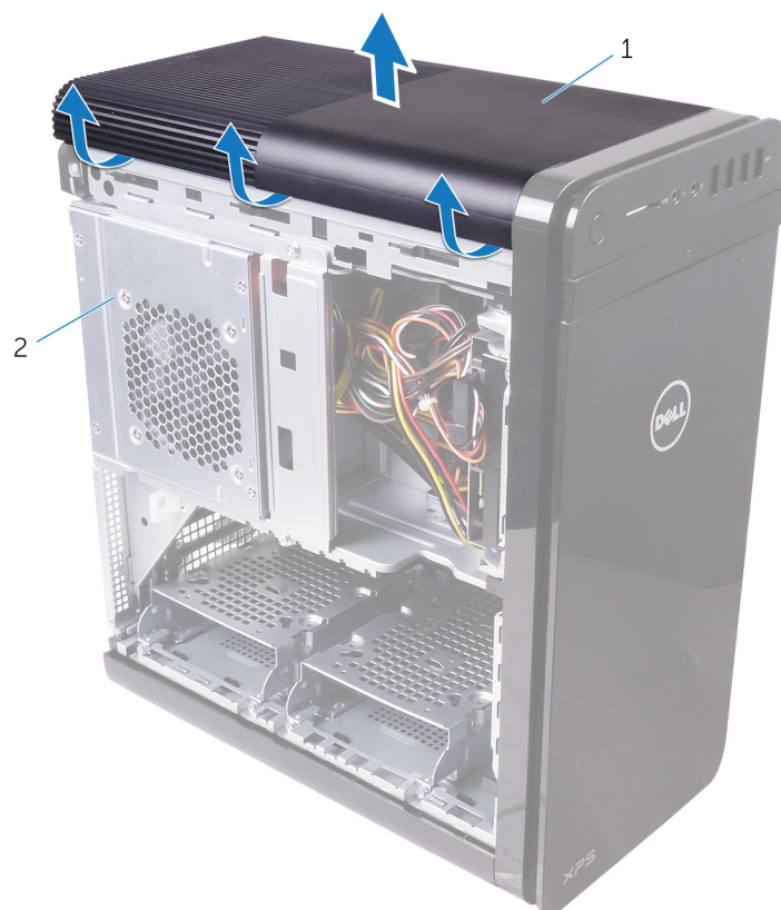
Figura 10. Rimozione del coperchio superiore
