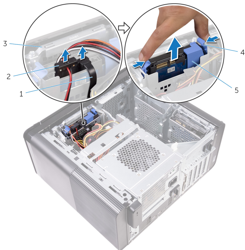
Figure 12. Retrait de l'assemblage du disque dur
