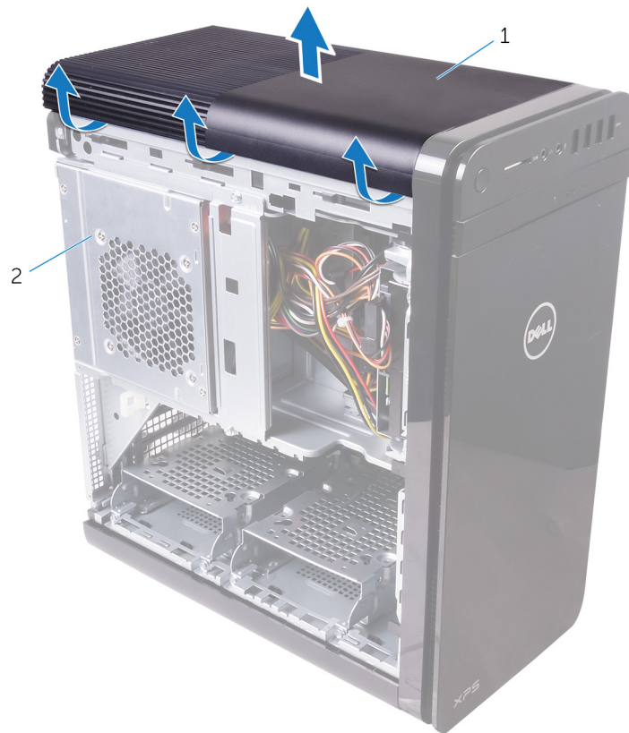
Abbildung 10. Entfernen der oberen Abdeckung
