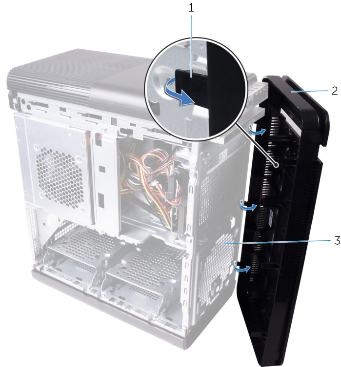
Abbildung 4. Entfernen der Frontverkleidung
