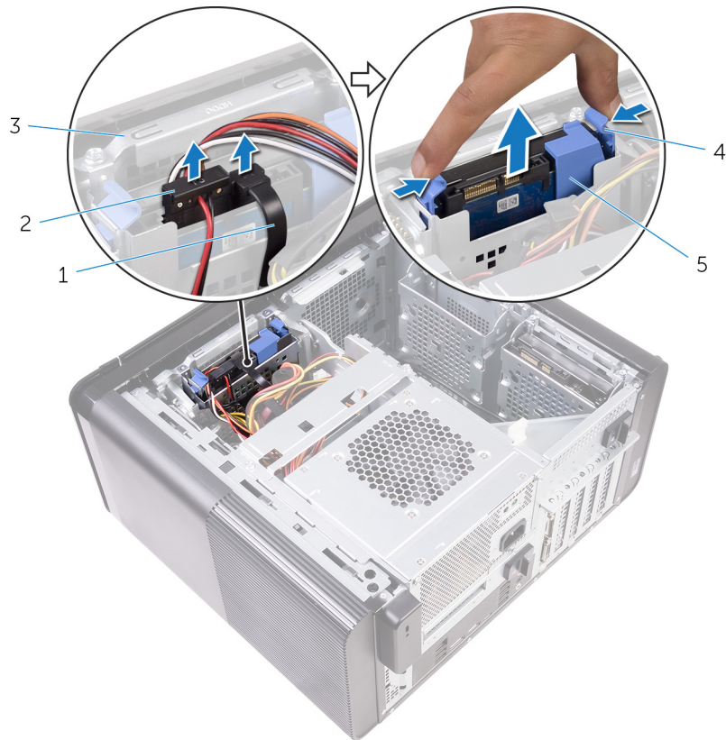
Abbildung 12. Entfernen der Festplattenbaugruppe
