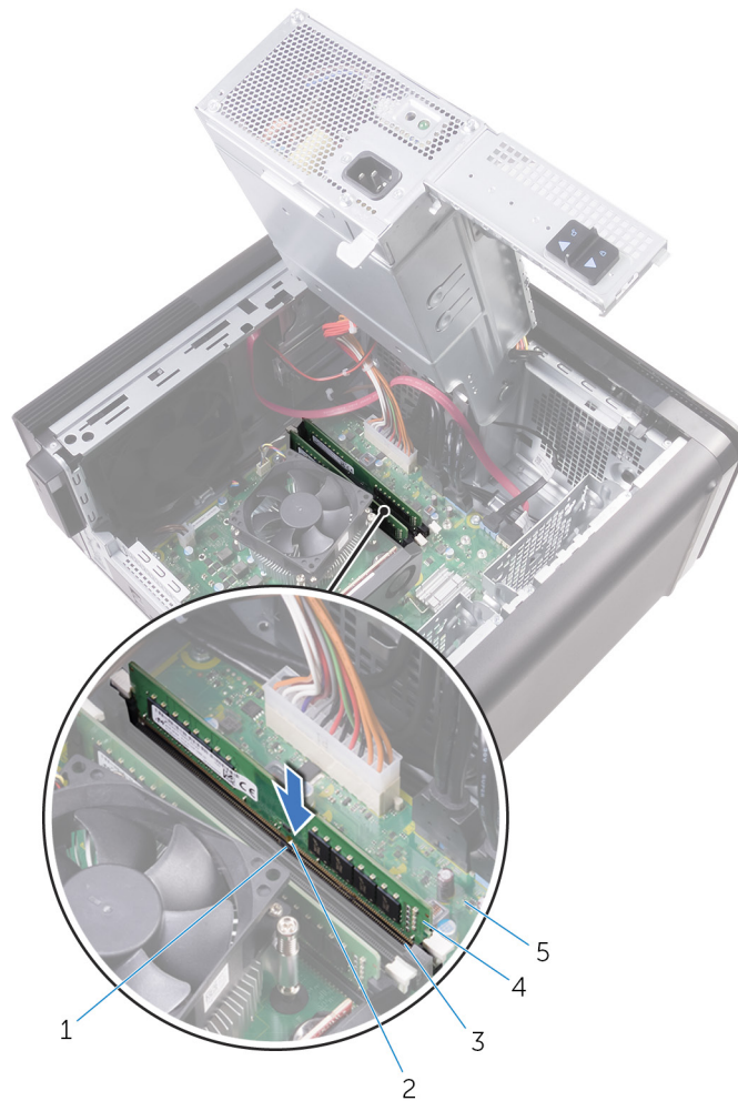
Abbildung 27. Wiedereinbau des Speichermoduls
