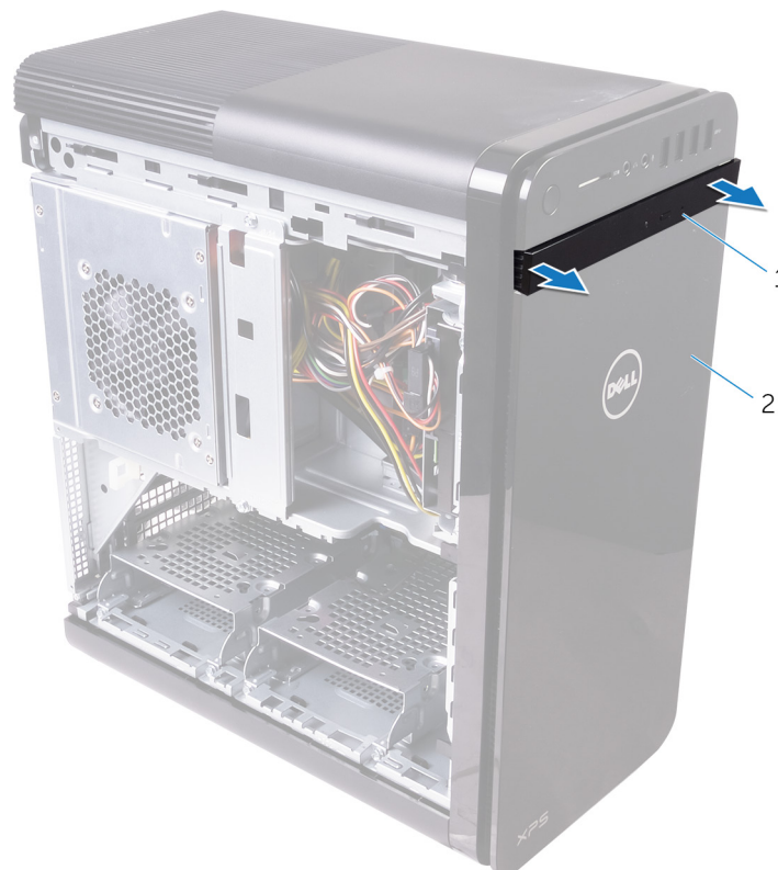
Abbildung 3. Entfernen der Blende des optischen Laufwerks
