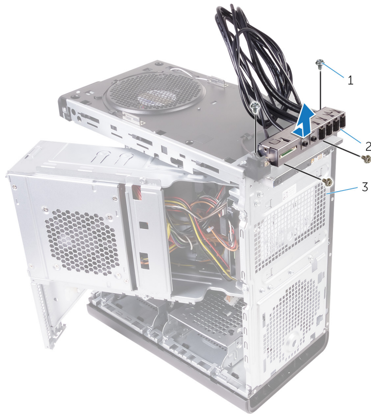
Abbildung 30. Entfernen der USB-Leiste
