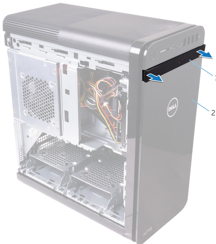
Obrázek 3. Demontáž čelního krytu optické jednotky
