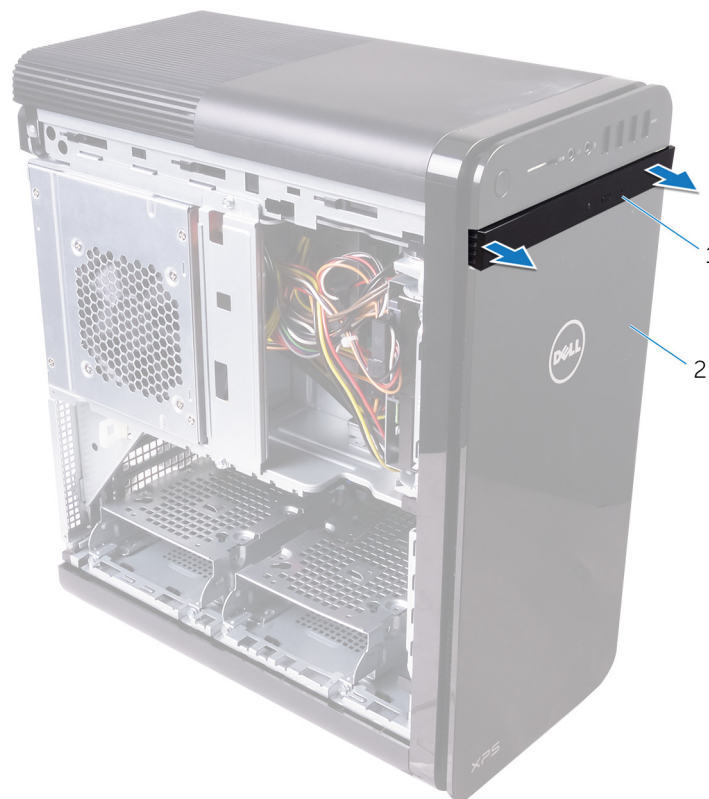
Figur 3. Ta bort den optiska enhetens ram
