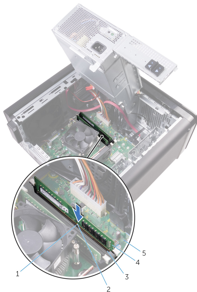
Obrázok 23. Spätná montáž pamäťového modulu
