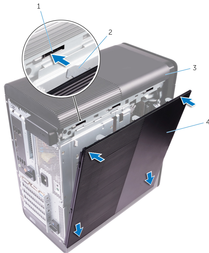
Obrázok 2. Montáž pravého bočného krytu na pôvodné miesto
