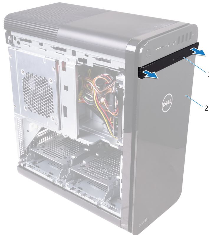
Obrázok 3. Demontáž rámu optickej jednotky
