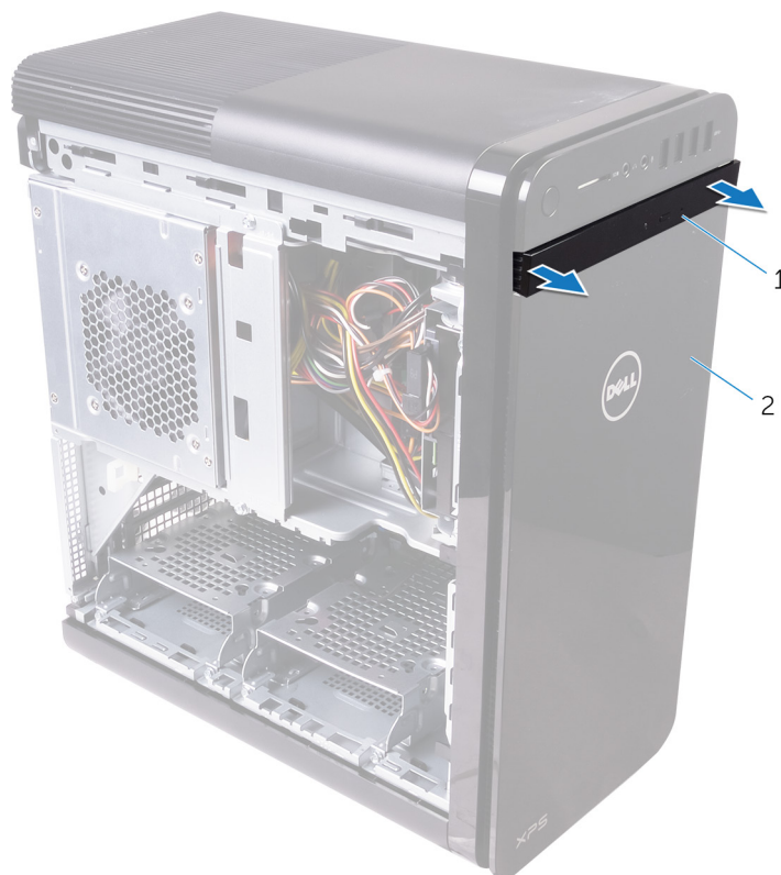
Рисунок 3. Удаление лицевой панели оптического привода
