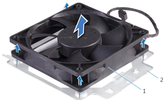
Рисунок 33. Снятие вентилятора корпуса
