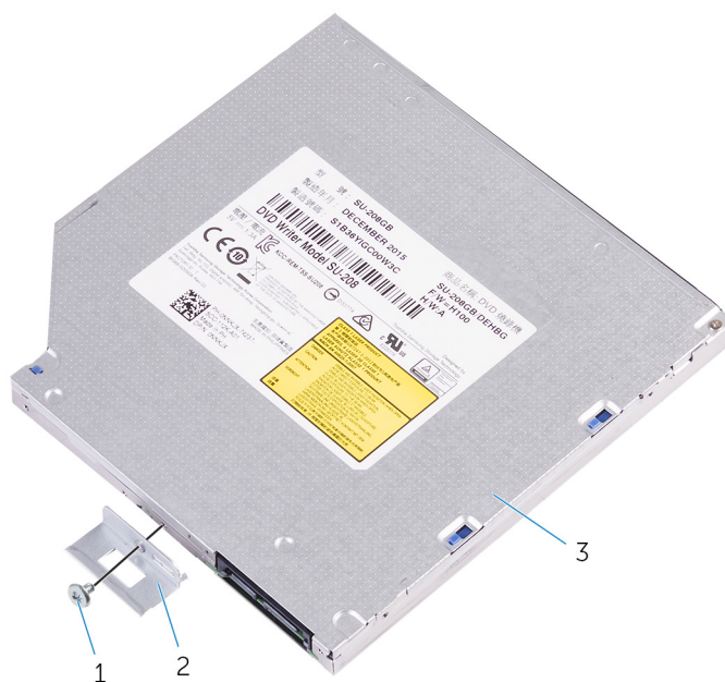
Рисунок 7. Извлечение оптического дисковода
