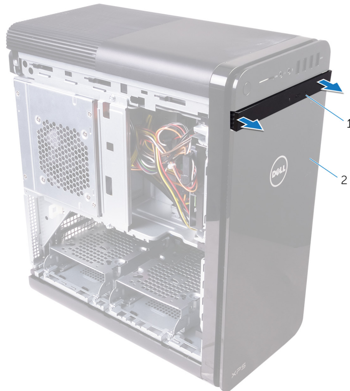
図 3. オプティカルドライブベゼルの取り外し
