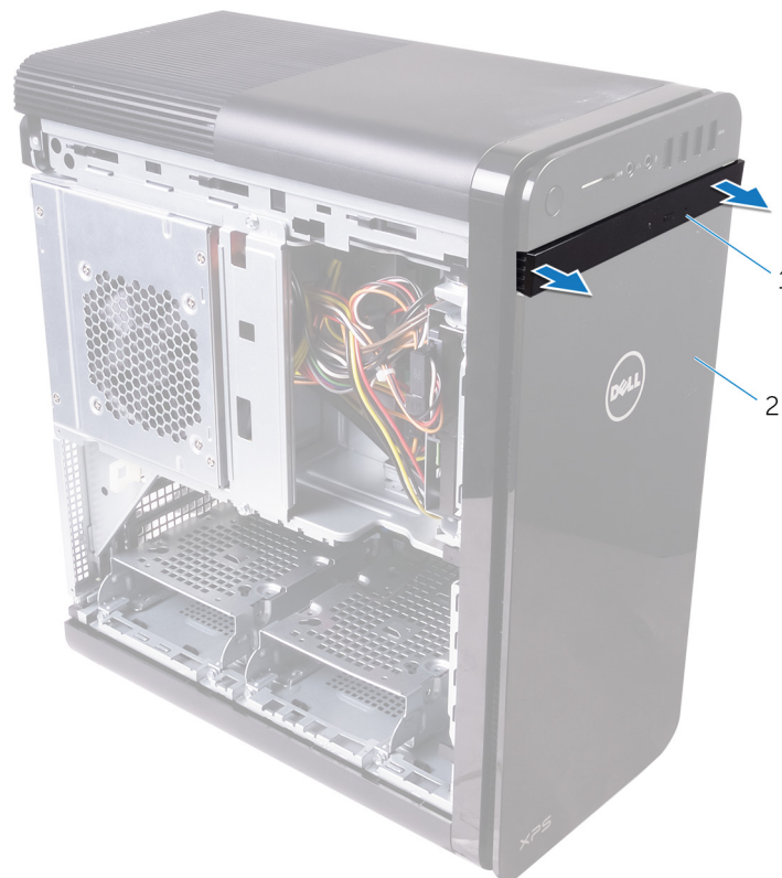
Figura 3. Rimozione del frontalino dell'unità ottica
