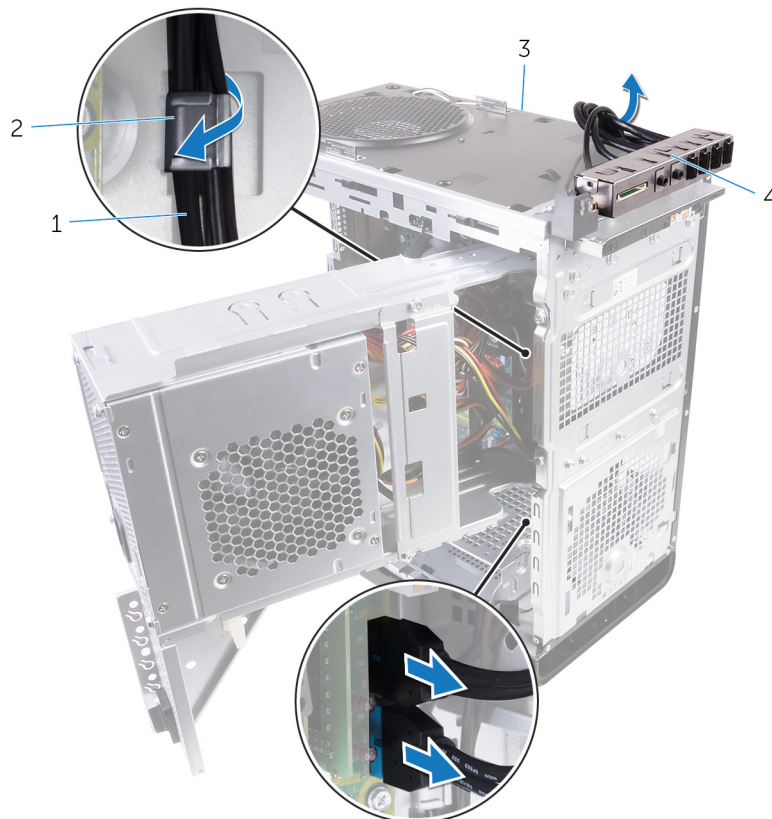
25. ábra. A kábelek lecsatlakoztatása
