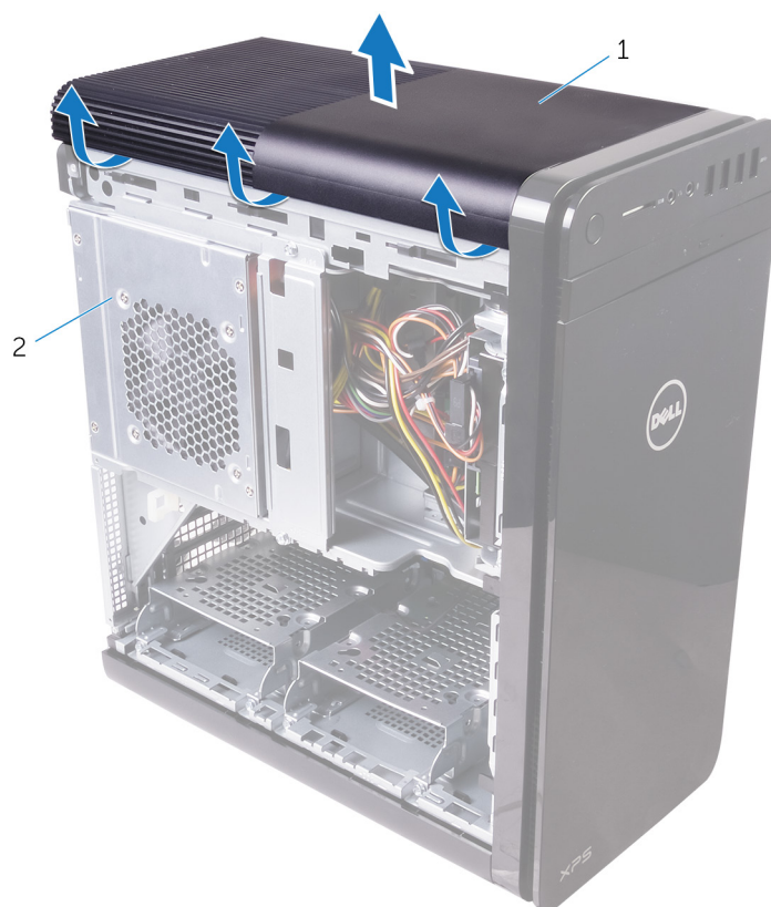
Figure 8. Retrait du capot supérieur de l'ordinateur
