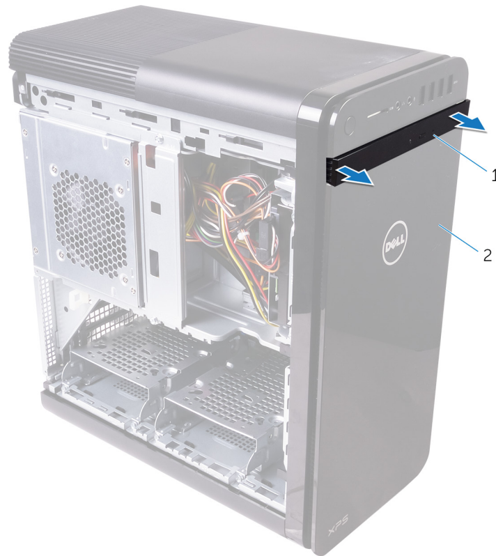
Kuva 3. Optisen aseman kehys irrottaminen
