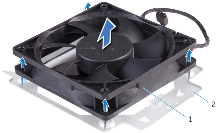
Kuva 33. Kotelon tuulettimen irrottaminen
