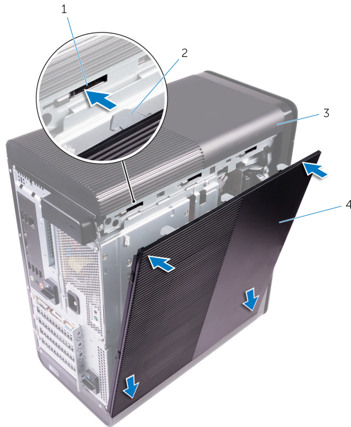
Kuva 2. Oikeanpuoleisen kannen asentaminen
