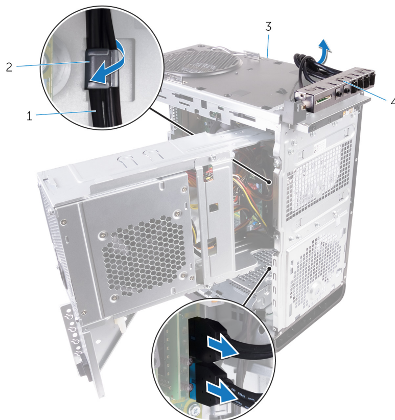
Ilustración 25. Desconexión de los cables
