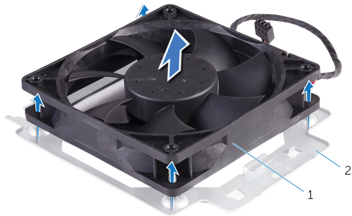
Ilustración 33. Extracción del ventilador del chasis
