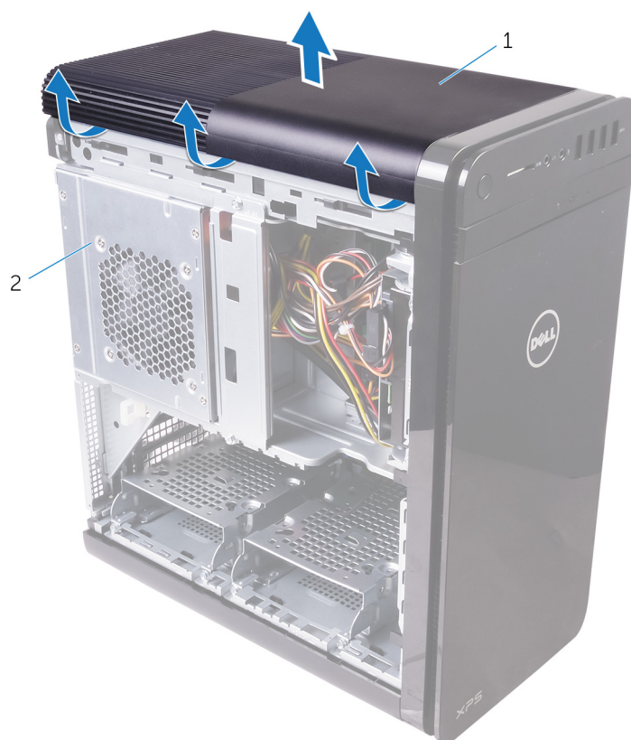
Ilustración 8. Extracción de la cubierta superior
