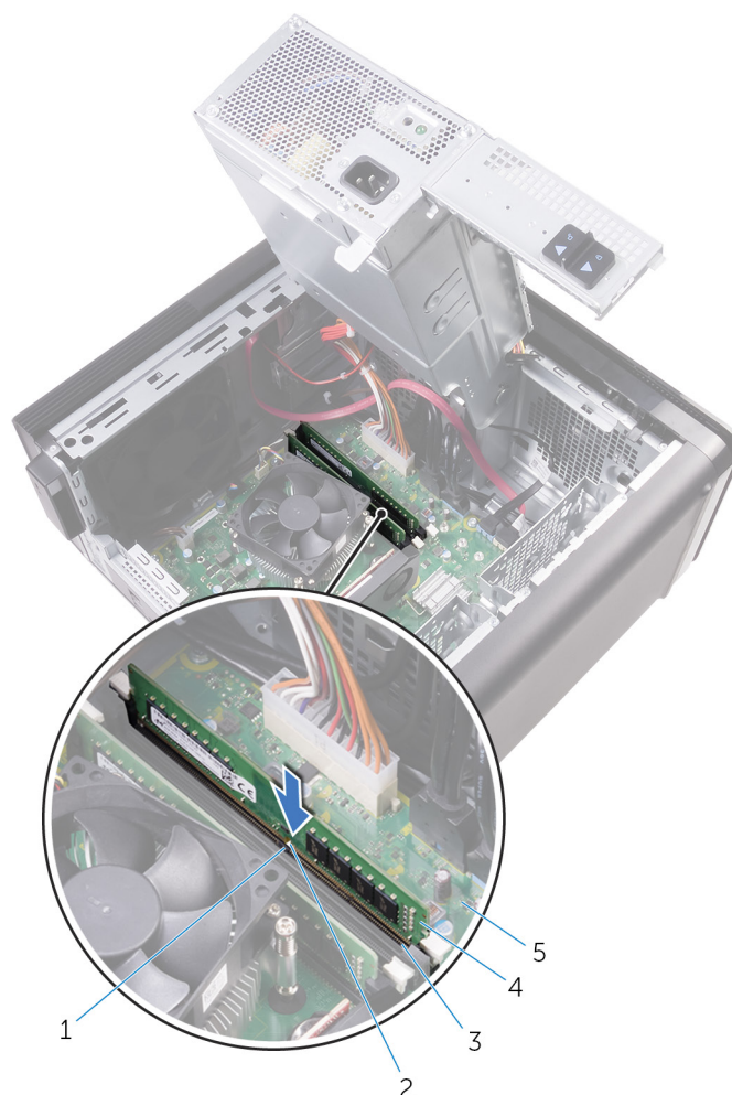
Ilustración 23. Colocación del módulo de memoria
