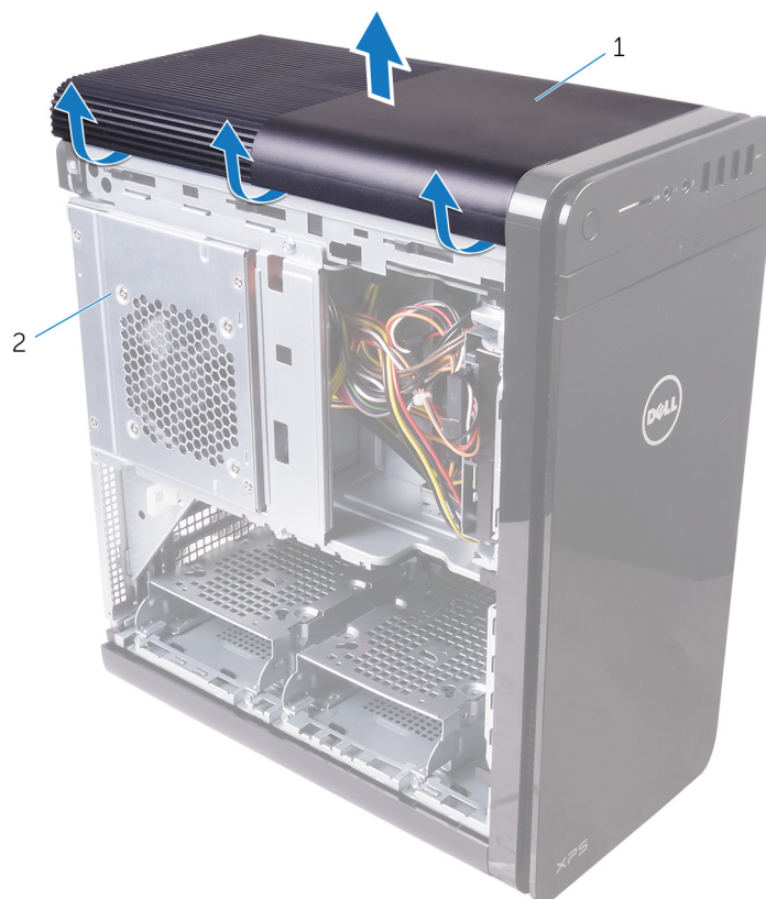
Abbildung 8. Entfernen der oberen Abdeckung
