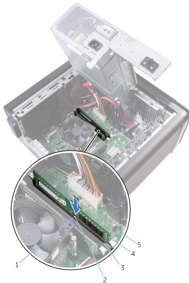
Abbildung 23. Wiedereinbau des Speichermoduls
