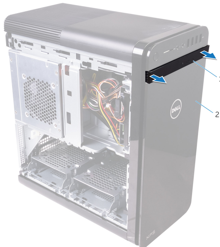
Abbildung 3. Entfernen der Blende des optischen Laufwerks
