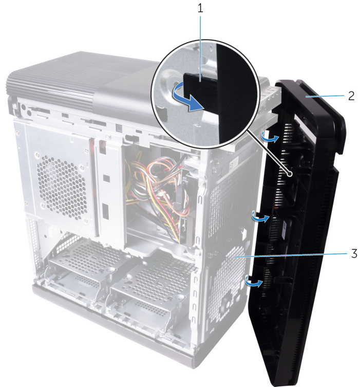
Abbildung 4. Entfernen der Frontverkleidung
