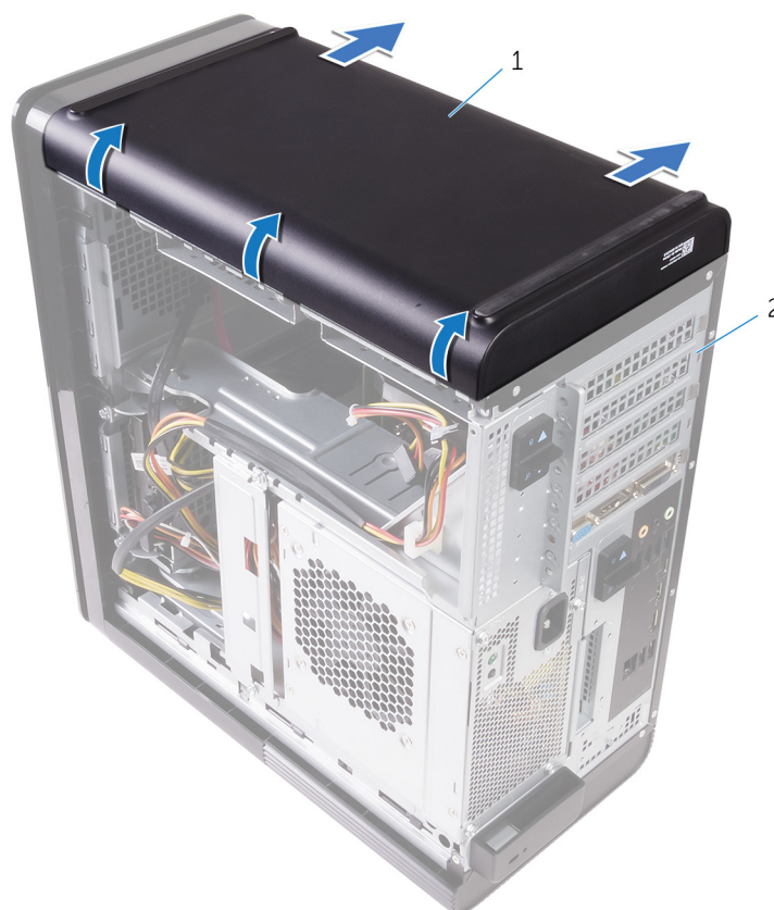
Abbildung 9. Entfernen der unteren Abdeckung
