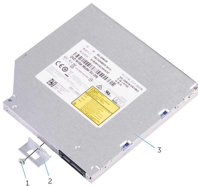
Abbildung 7. Entfernen des optischen Laufwerks
