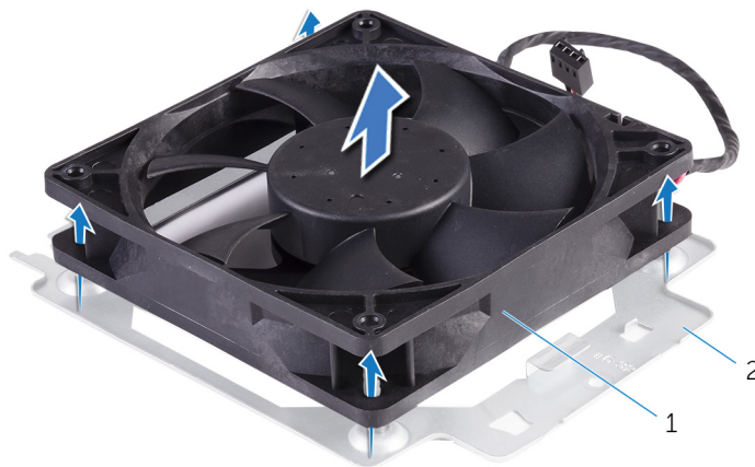
Abbildung 33. Entfernen des Gehäuselüfters
