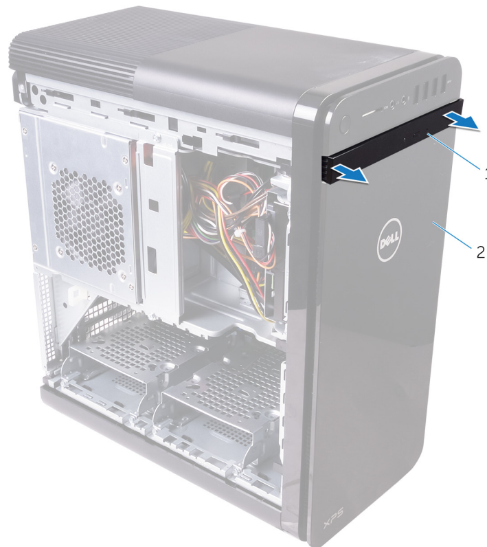
Abbildung 3. Entfernen der Blende des optischen Laufwerks
