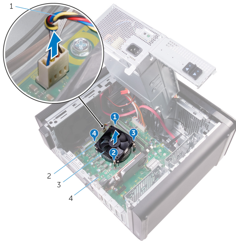
Abbildung 31. Entfernen von Prozessorlüfter und Kühlkörper
