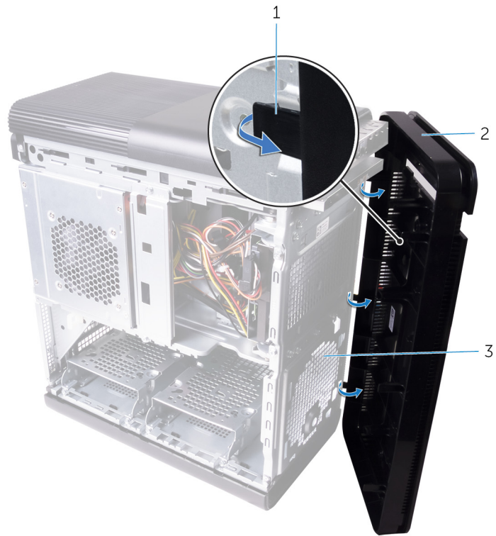
Abbildung 4. Entfernen der Frontverkleidung
