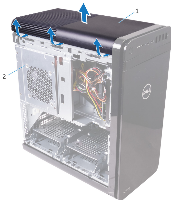
Abbildung 8. Entfernen der oberen Abdeckung
