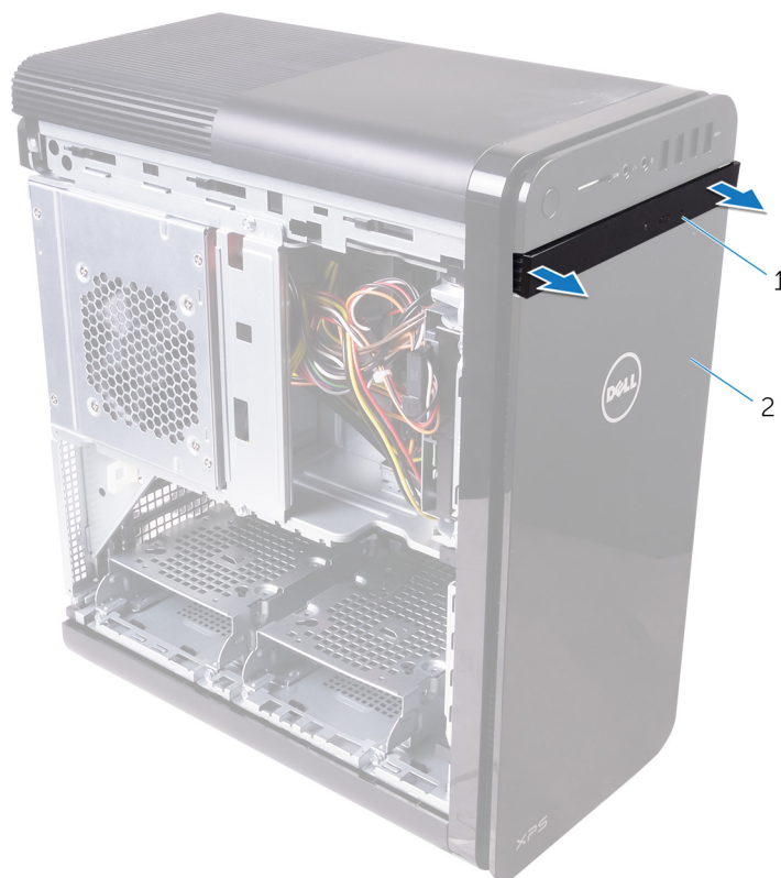
Obrázek 3. Demontáž čelního krytu optické jednotky
